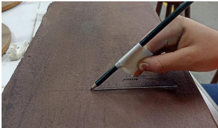
Realización de ensayo sobre muro de albañilería usando en lápiz a 45° grados.
