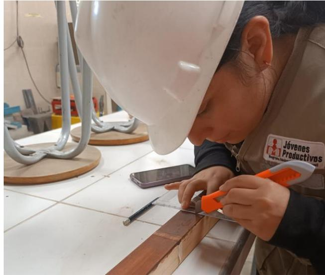
Realización de ensayo sobre madera, con el uso de una cortadora para realizar la cuadrilla que especifica la norma ASTM D3359 (2017).
