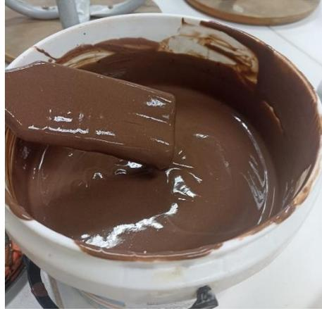
El resultado obtenido es un barniz con poco brillo, sin embargo, presenta características de manejabilidad para realizar el recubrimiento tanto en madera como en muro de albañilería. De la misma forma, se observó que éste no logra agarrar un color muy oscuro, además desde la primera capa, logra generar un cubrimiento perfecto, dándole un color uniforme. Consigue ser inoloro y no llega a afectar al ambiente. Finalmente, se tiene un barniz con consistencia líquida.
