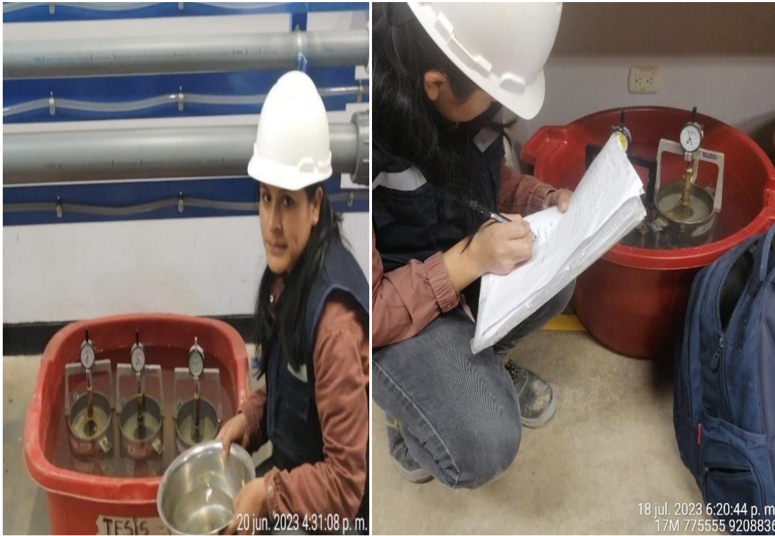
Figura 8. Hinchamiento. En esta imagen se puede apreciar el proceso de realización del ensayo de hinchamiento, utilizado para analizar la expansión y el aumento de volumen de los suelos que están siendo estudiados.
