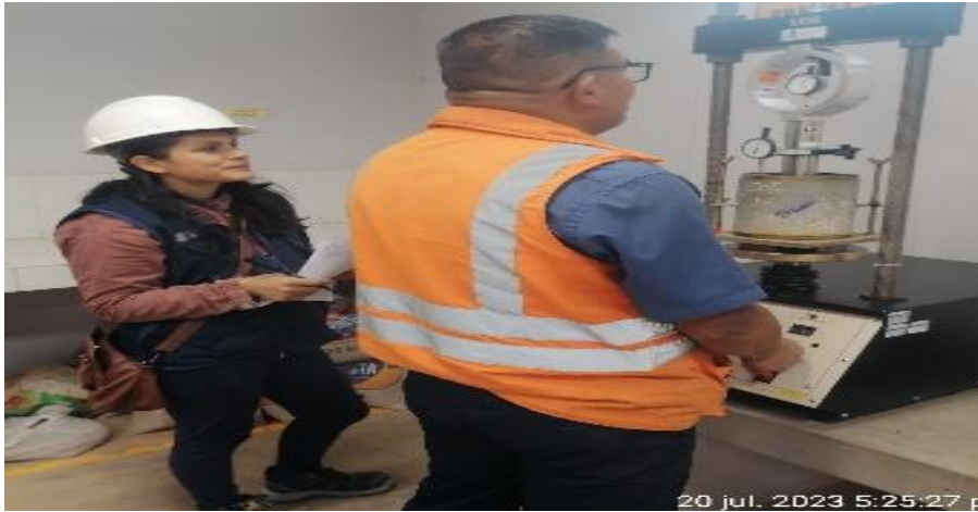
Figura 9. Penetración. En esta imagen se observa la ejecución del ensayo de penetración en las para introducir el pistón a una profundidad de 2.54 mm.
