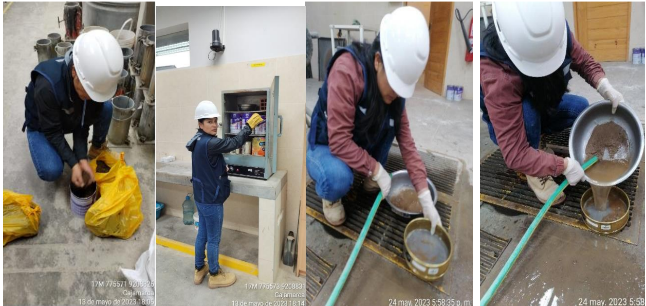
Figura 1. Contenido de humedad. En esta imagen se puede observar el proceso para poder determinar el contenido de humedad de las muestras extraídas, una actividad esencial para la evaluación de las variaciones en el volumen de los suelos.
