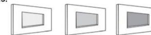
Vidrio claro Transmisancia visible: 0.88 (alta) Vidrio entintado Transmisancia visible: 0.53 (media) Vidrio reflectivo Transmisancia visible: 0.39 (baja)
