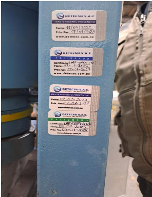
Fechas de Calibración y mantenimiento de instrumento prensa hidráulica
