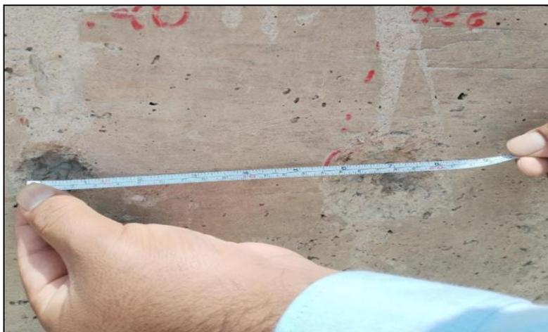
**Nota:** Esta figura muestra la medida del desplazamiento, las perforaciones que se realizan para la investigación, elaboración propia.
