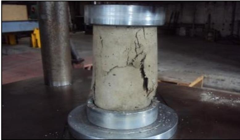
**Nota:** Esta figura muestra la Resistencia a la compresión.
