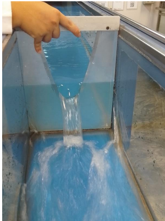
Ilustración 55: Vertedero triangular calibrado de 53° 7'
