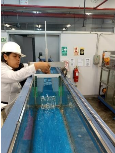
Ilustración 14 : Midiendo la altura con ayuda del limnómetro
