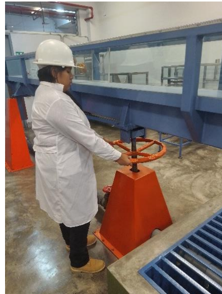
Ilustración 52: Comprobando la pendiente
