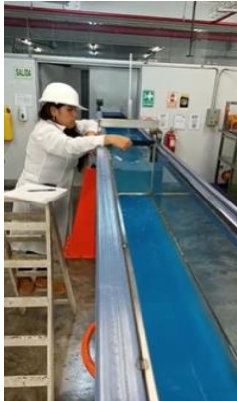
Ilustración 57: Uso de los vertederos en canal de pendiente variable y la medida de la altura con el limnómetro
