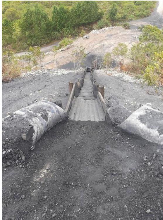
Foto N°3: Canaleta, la cual transporta el mineral de la bocamina a la zona de zarandeo
