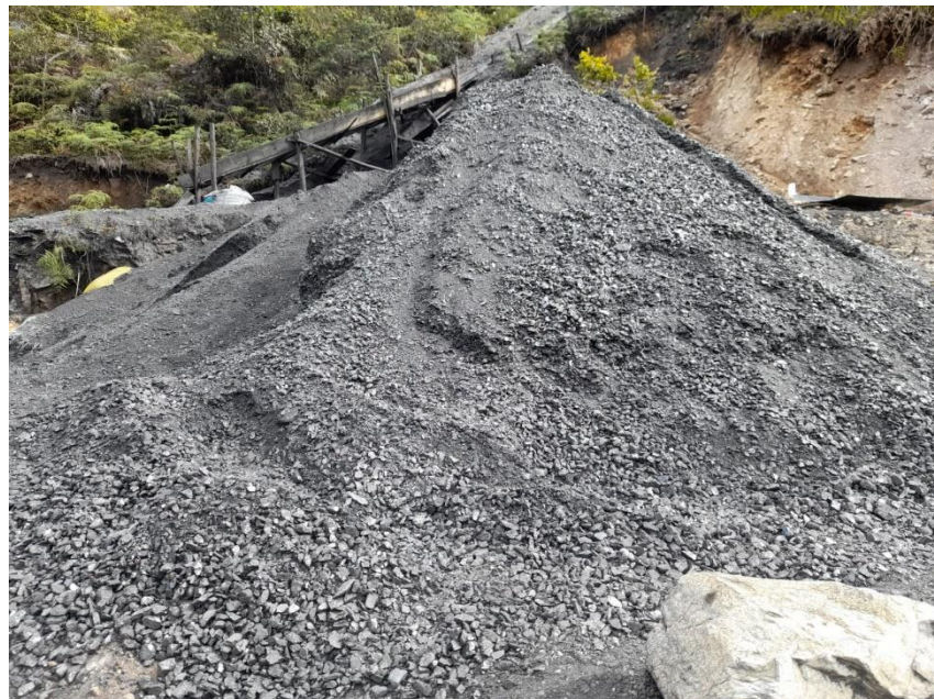
Foto N°3: Canaleta, la cual transporta el mineral de la bocamina a la zona de zarandeo
