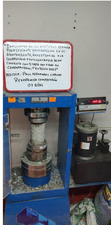
Fotografía 10 Ensayo de resistencia a la compresión de testigo de concreto a la edad de 7 días.
