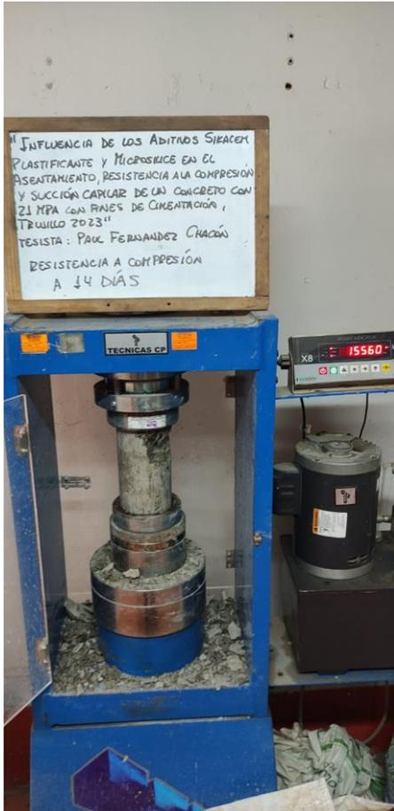
*Fotografía 10* Ensayo de resistencia a la compresión de testigo de concreto a la edad de 14 días.
