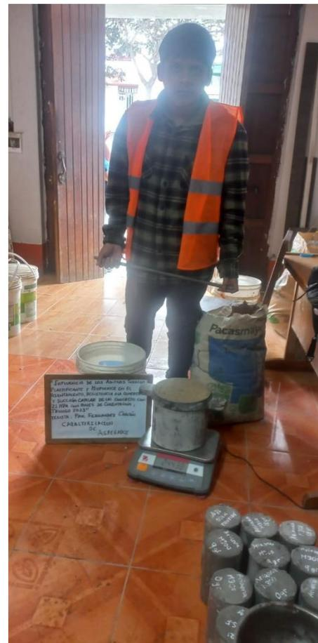
*Fotografía 2* Realizando el ensayo de peso unitario compactado del agregado fino.
