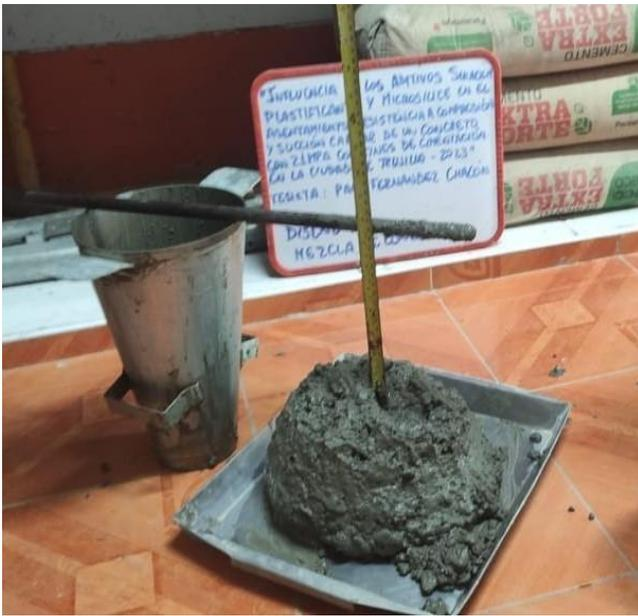
*Fotografía 5* Asentamiento de la mezcla con 0.8% de aditivo plastificante SikaCem.
