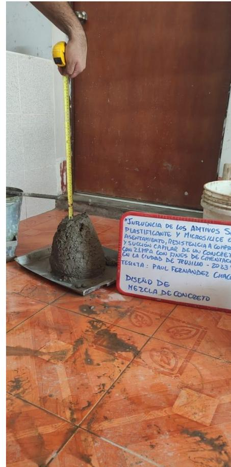
*Fotografía 6* Asentamiento de la mezcla con la adición del 6% microsílíce SikaFume.
