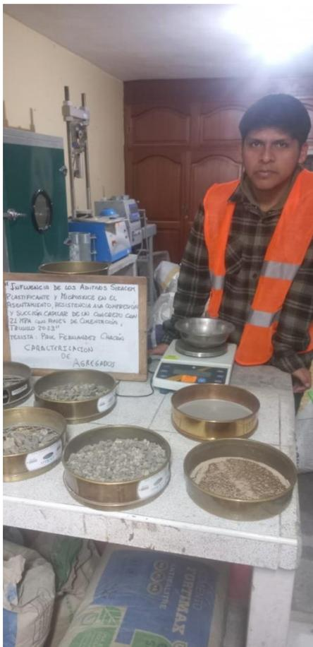
*Fotografía 1* Realizando el ensayo de granulometría del agregado grueso.
