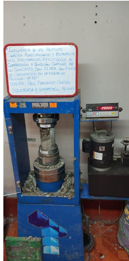
*Fotografía 10* Ensayo de resistencia a la compresión de testigo de concreto a la edad de 28 días.
