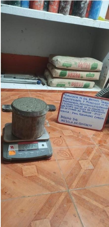
Fotografía 7 Ensayo de peso específico del concreto en estado fresco.
