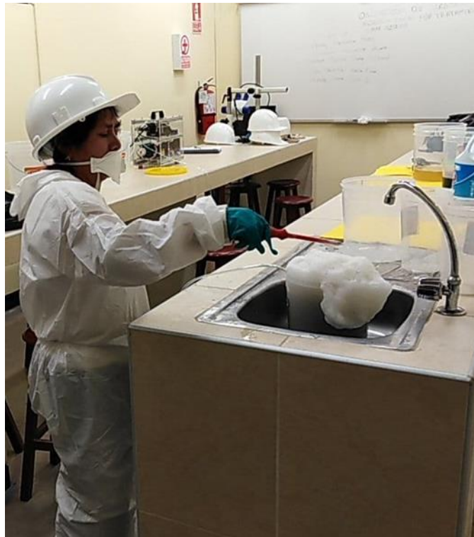
Figura 10. Aplicación del ozono al lixiviado (2 de 2)
