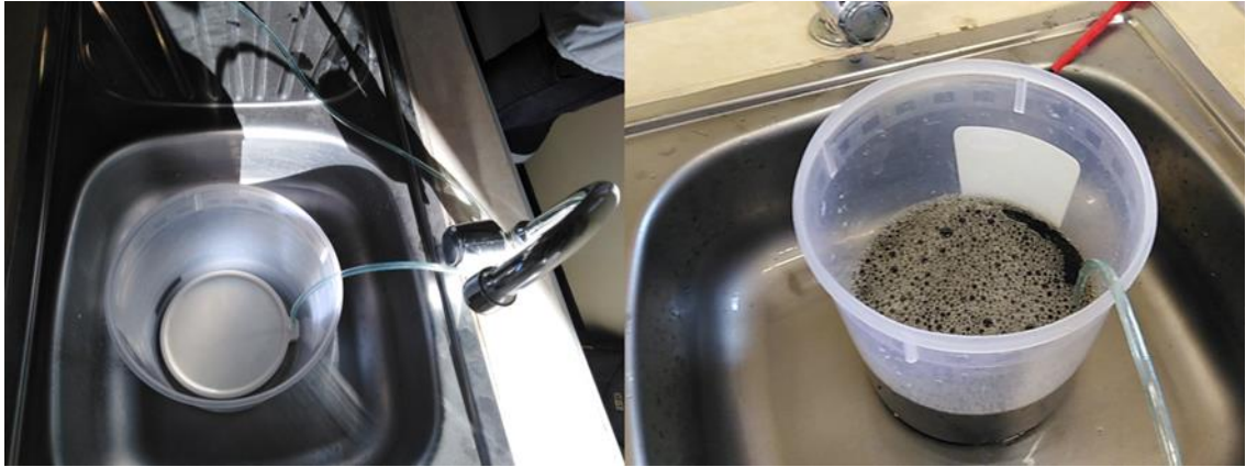
Figura 9. Aplicación del ozono al lixiviado (1 de 2)
