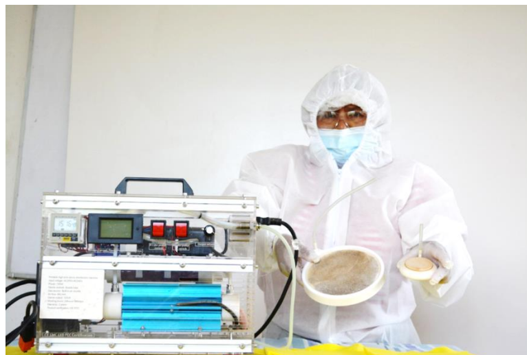
Figura 8. Equipo generador de ozono
