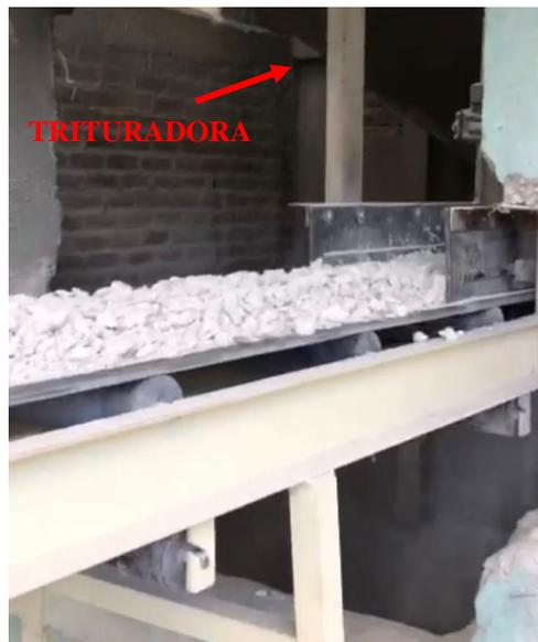
*Figura N° 27: Banda transportadora que conecta trituradora con molino.*
