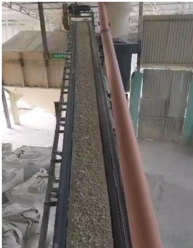
*Figura N° 31: Banda transportadora que conecta el molino con el silo.*
