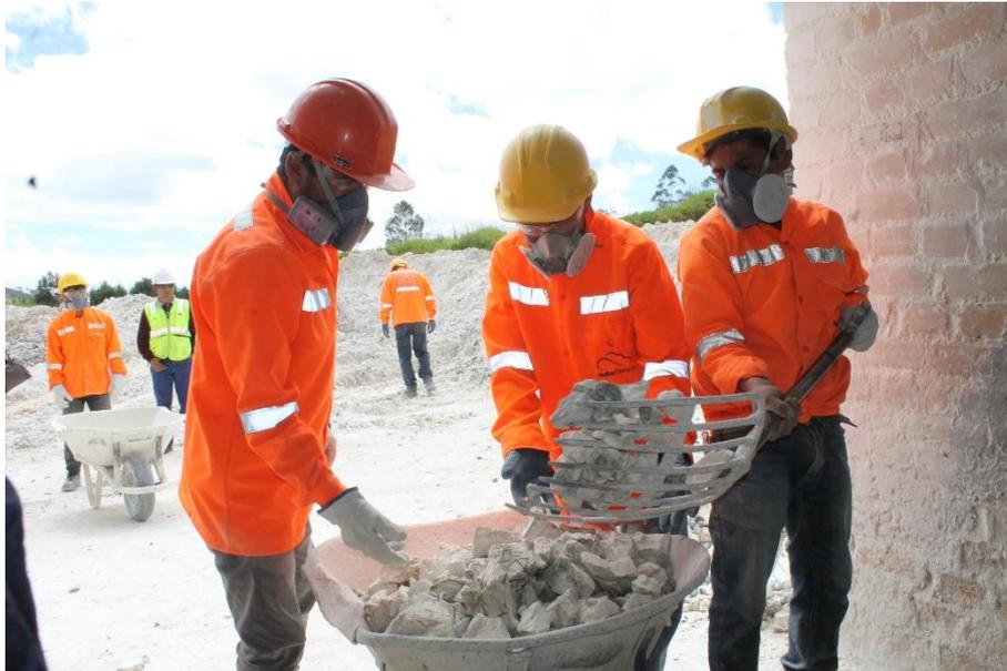
*Figura N° 13: Extracción de CaO del horno*
