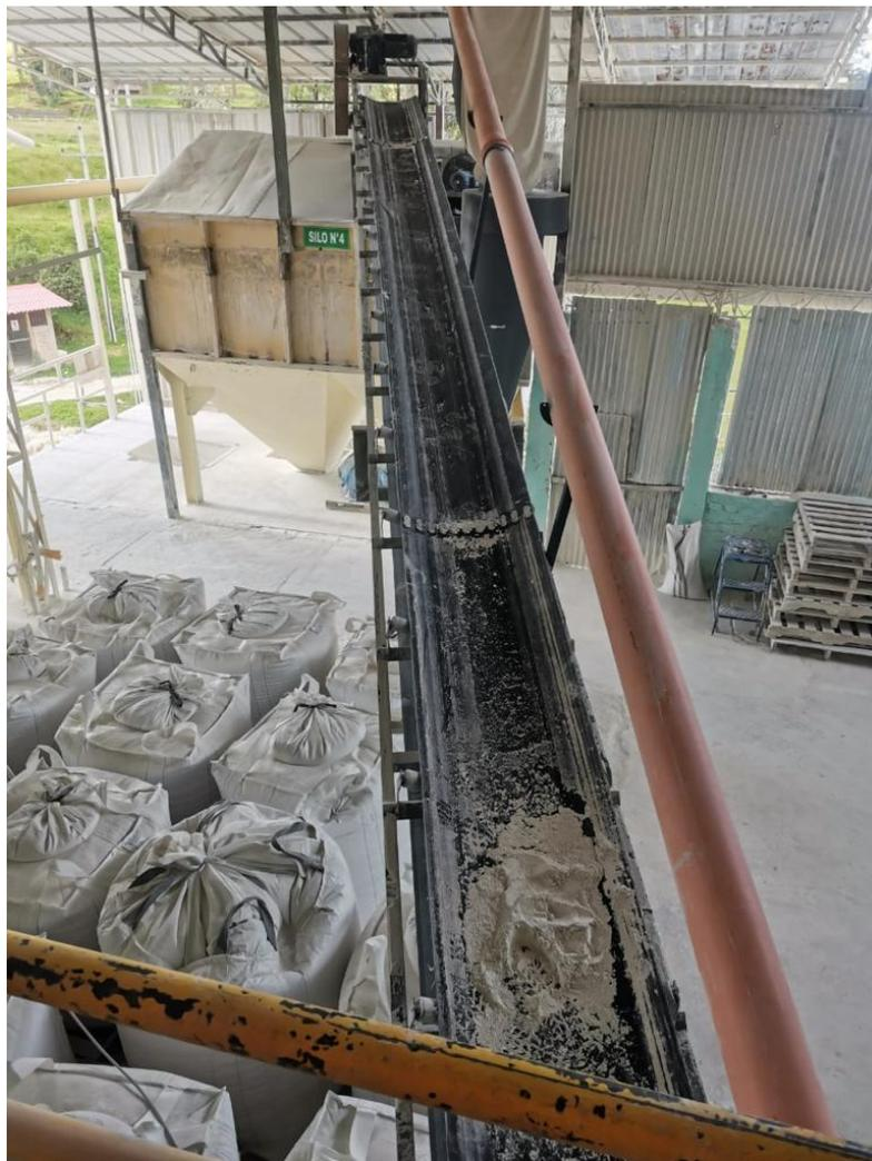
*Figura N° 42: Banda Transportadora que une el Molino con Silo de almacenamiento.*
