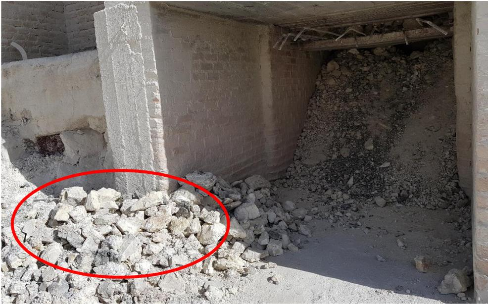
*Figura N° 39: Zona de separación de CaO mal calcinado.*
