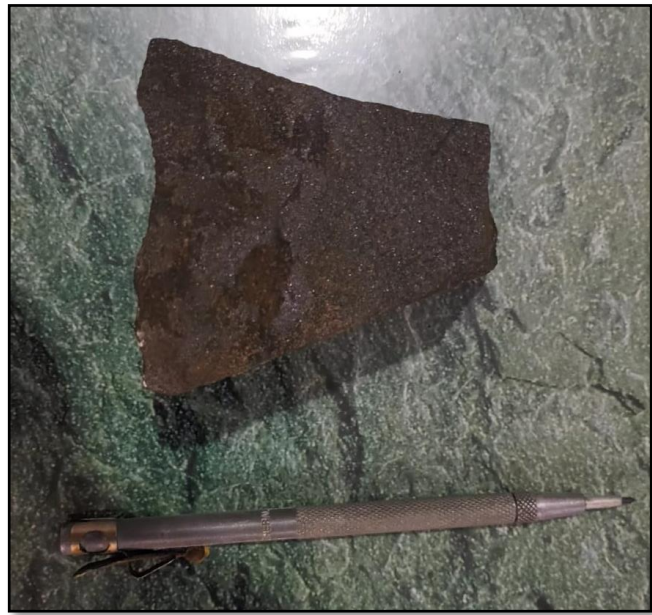
Figura 48: Arenisca con presencia de óxidos de hierro (Hematita + Magnetita) + Óxidos de manganeso
