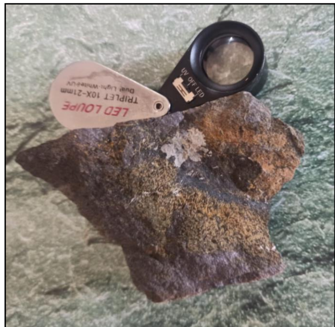
Figura 21: Areniscas con presencia de óxidos de hierro (Limonita + Hematita + Goethita + Magnetita) + Óxidos de manganeso
