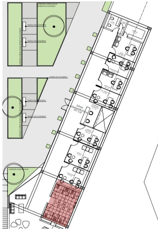
Figura 90: Aparatos Sanitarios Zona Administrativa
