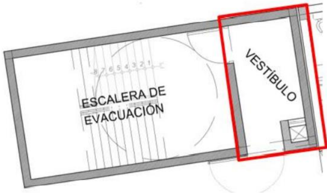
Figura 87: Escalera de Evacuación Normativa
