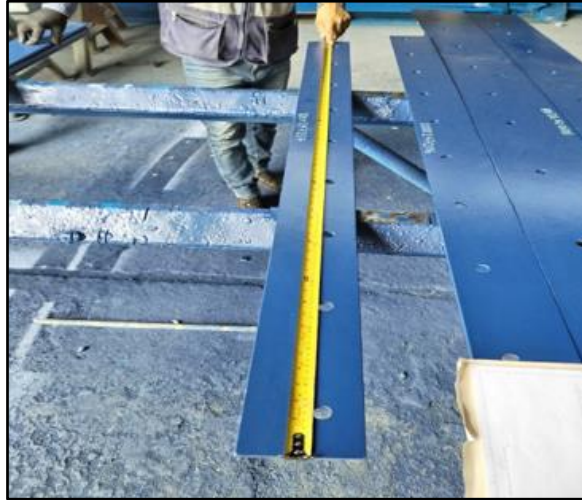
Figura 50: Inspección de dimensiones
