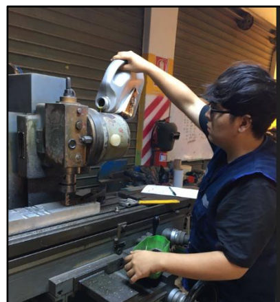
Figura N°25: Mantenimiento correctivo por fuga de aceite en el cabezal
