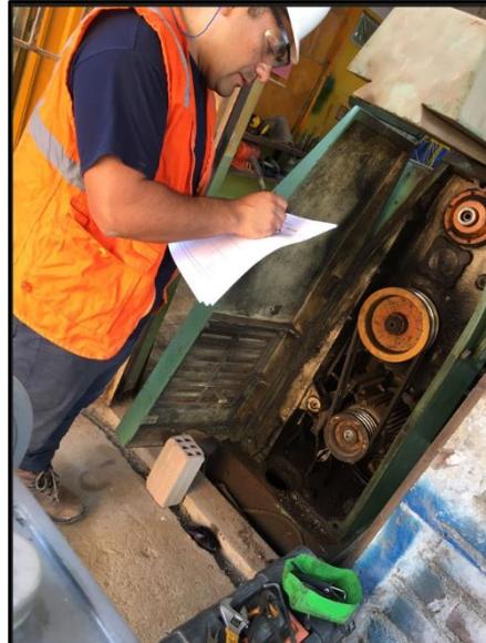
Figura N°20: Llenado de la Orden de Trabajo para mantenimiento de las fajas incorrectamente templados.
