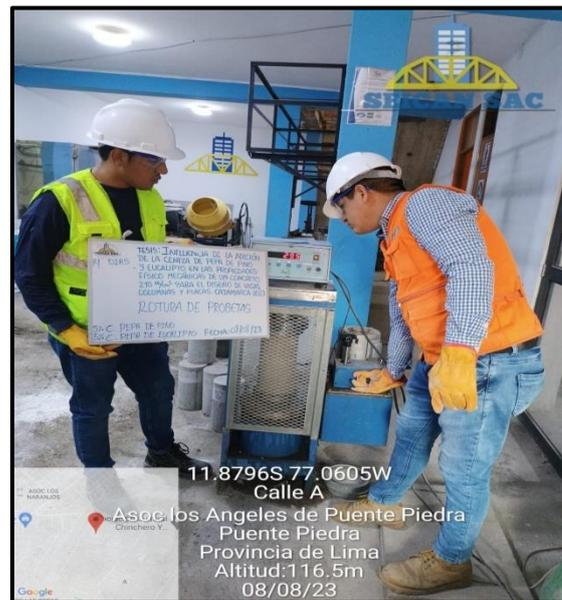
**Fotografía N. 54: Rotura de probetas 6"x12" a 28 días**
