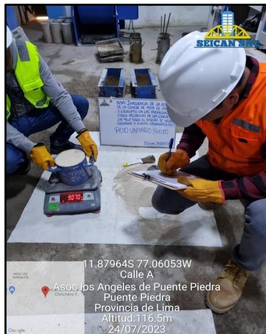
**Fotografía N. 25: Peso Unitario Compactado – Agregado Fino**
