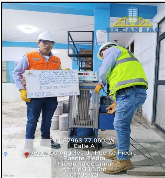
**Fotografía N. 53: Rotura de probetas 6"x12" a 14 días**
