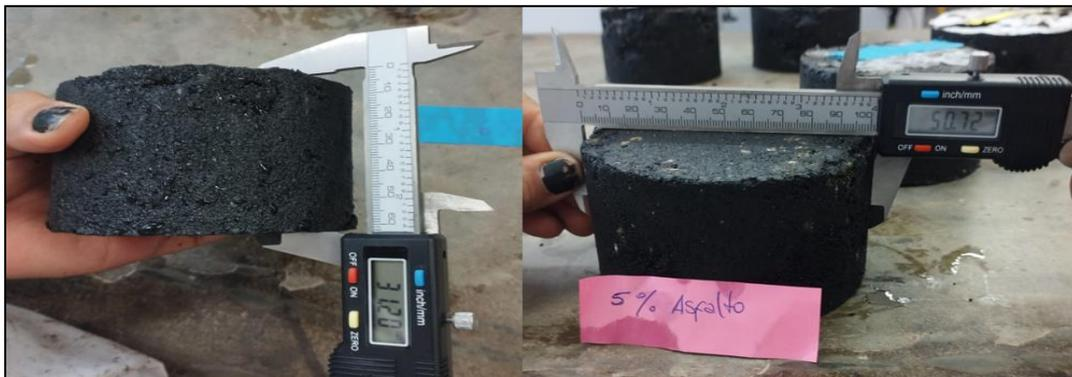
Asimismo, las muestras se acondicionaron para obtener una temperatura uniforme, para ello se sumergieron en agua a una temperatura de 60° centígrados 30 minutos.
