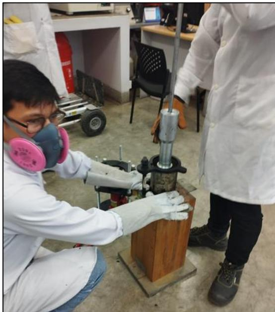
Una vez que la compactación está completa, se permite que las briquetas reposen en los moldes para permitir un proceso de enfriamiento y endurecimiento. Después de este tiempo de reposo, se procede al desmoldado de las briquetas. Para facilitar este
