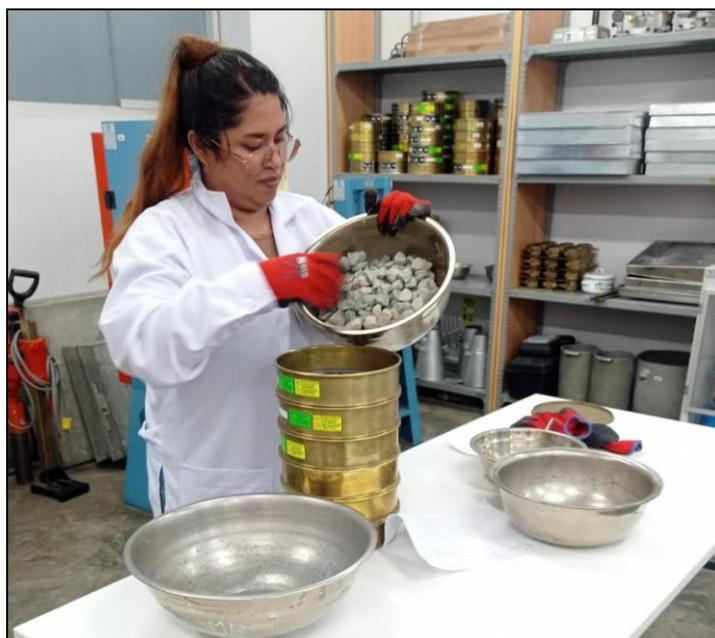
Una vez completado el tamizado, se procedió a pesar cada fracción retenida en las mallas para calcular los porcentajes acumulados de material retenido. Finalmente, con estos datos, se graficó la curva granulométrica para obtener una visualización clara de la distribución de tamaños de partículas presentes en el suelo analizado.
