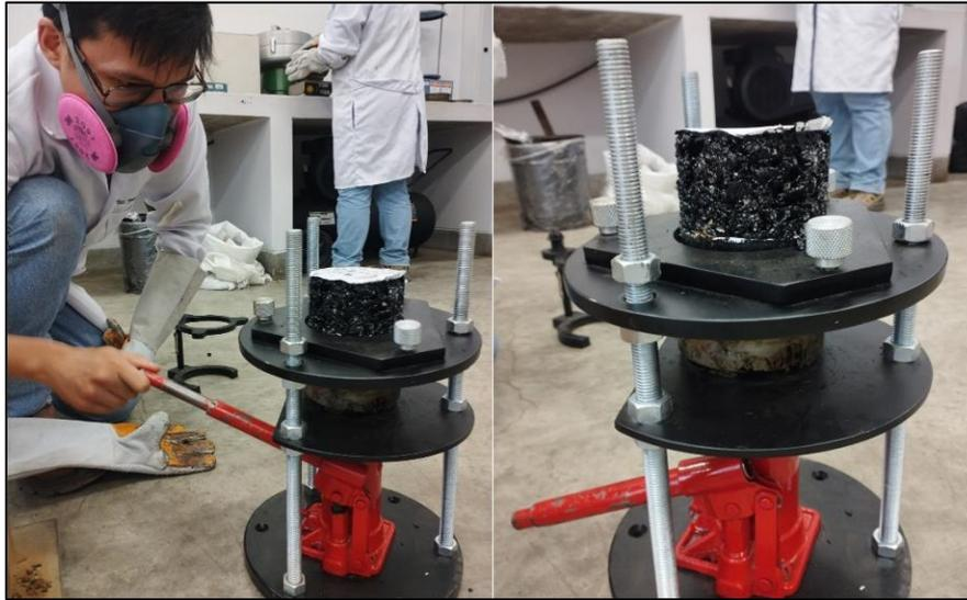
Finalmente, se obtienen las briquetas asfálticas listas para su uso o para someterlas a pruebas y ensayos que permitan evaluar sus propiedades.
