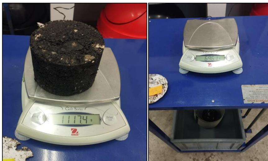
Luego de ello, la briketa se sumergió completamente en agua durante unos minutos para asegurar que el agua penetre en los poros y espacios vacíos de la mezcla asfáltica. Tras ello se procedió a pesar la briketa sumergida. Finalmente, con los datos obtenidos se calculó el % de vacíos.
