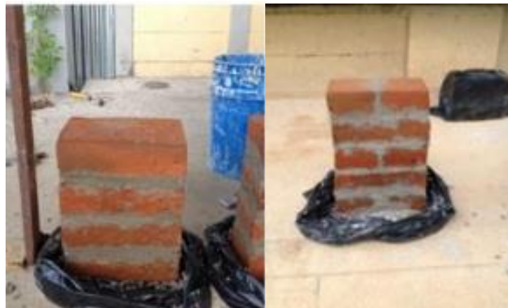
Figura 7. Construcción de pilas
