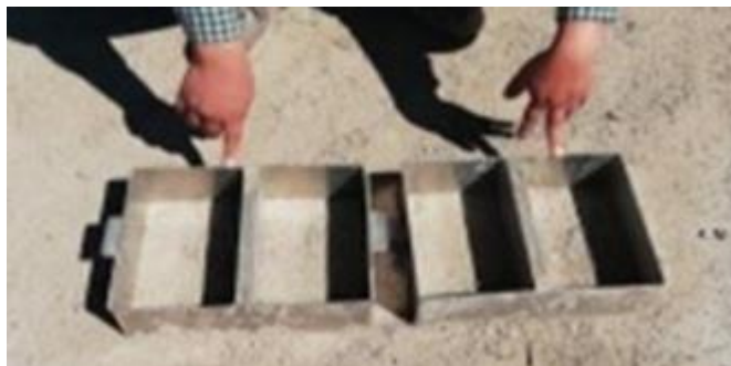
Figura 4. Moldes de unidades de albañilería - mezcla de poliestireno
