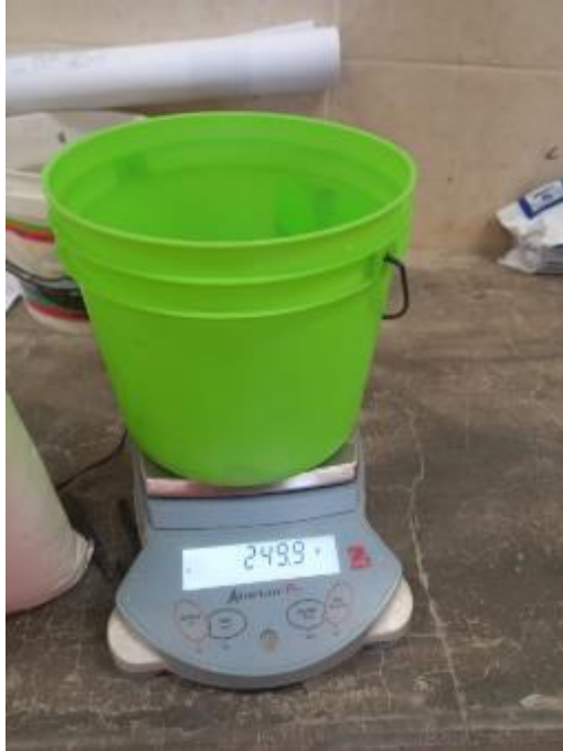
Foto 3: Balde y balanza para pesar los materiales.
