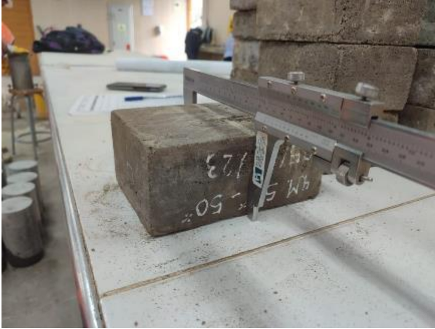
Foto 9: Ensayo de variación dimensional de las unidades de albañilería.
