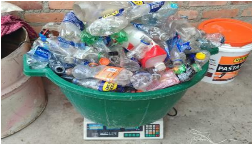
Foto 6: Recolección de plástico para elaborar los ladrillos de la dosificación 50:50 a base de plástico fundido y arena.
