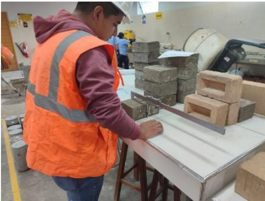
Foto 10: Ensayo de variación dimensional de las unidades de albañilería en diversas dosificaciones.
