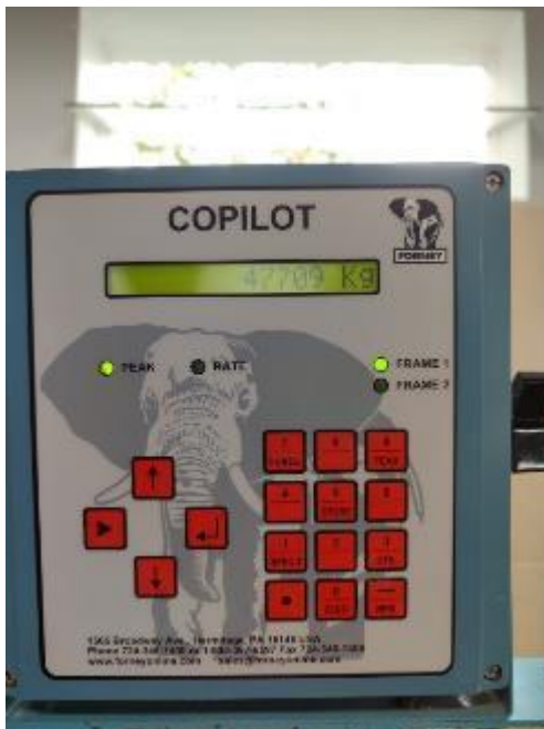
Foto 14: Mayor resistencia a la compresión obtenida de la muestra de la dosificación 50%:50% a base de plástico fundido y arena.
