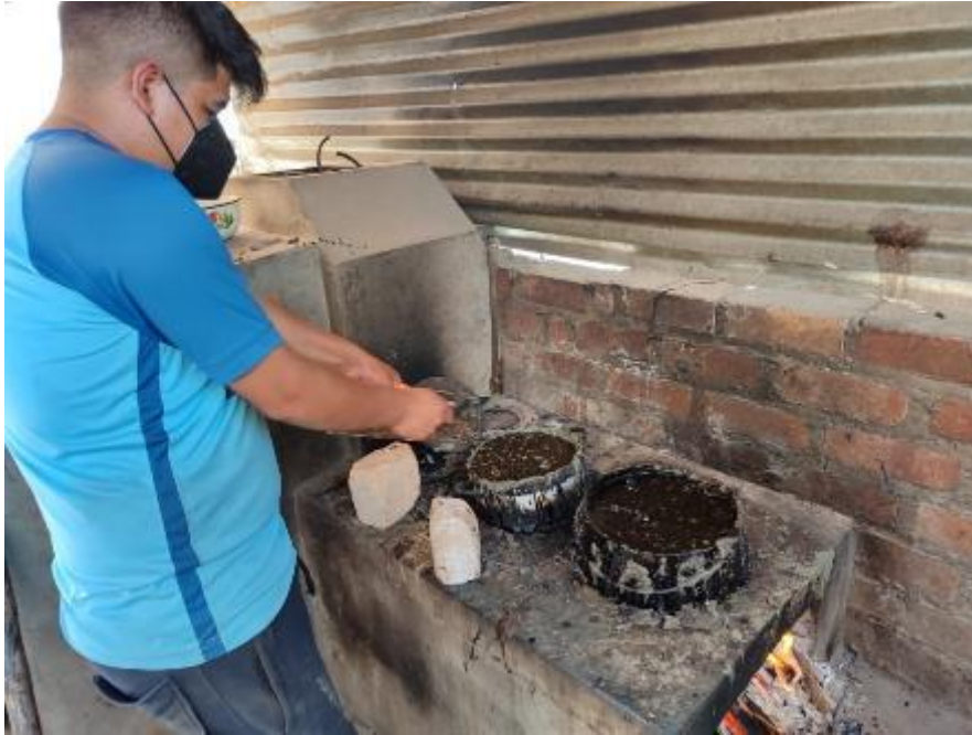
Foto 7: Fundición de plástico para la elaboración de las unidades de albañilería en diversas dosificaciones
