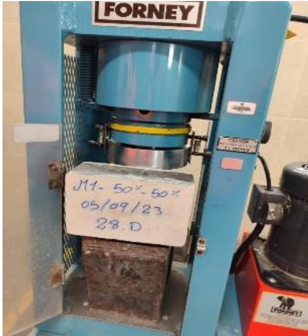
Foto 13: Compresión de la unidad de albañilería de la dosificación 50%:50% a base de plástico fundido y arena.
