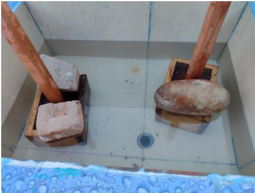
Foto 8: Elaboración de las unidades de albañilería en las diversas dosificaciones a base de plástico fundido y arena.
