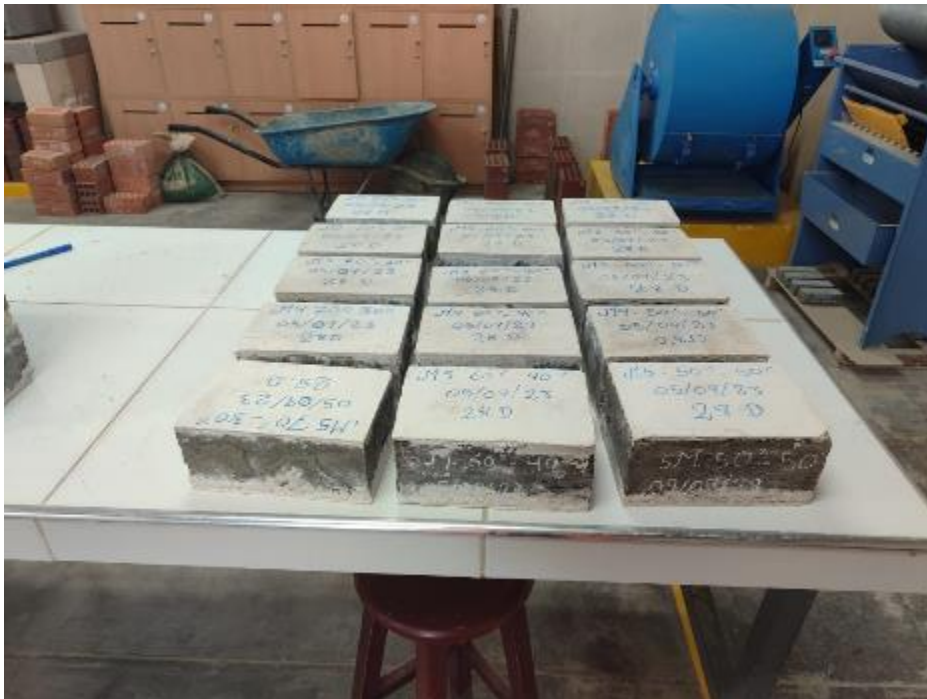
Foto 12: Muestras codificadas para el ensayo de resistencia a la compresión en diversas dosificaciones.
