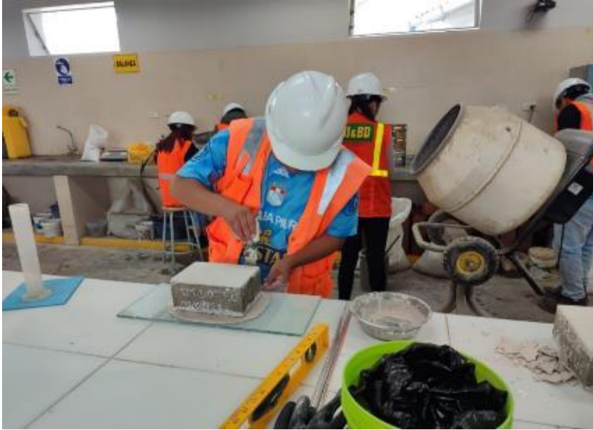
Foto 11: Colocación de la capa de yeso en las diversas unidades de albañilería.
