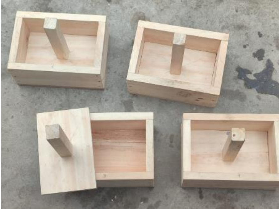
Foto 1: Molde de madera para elaboración de ladrillos a base de plástico fundido y arena.
