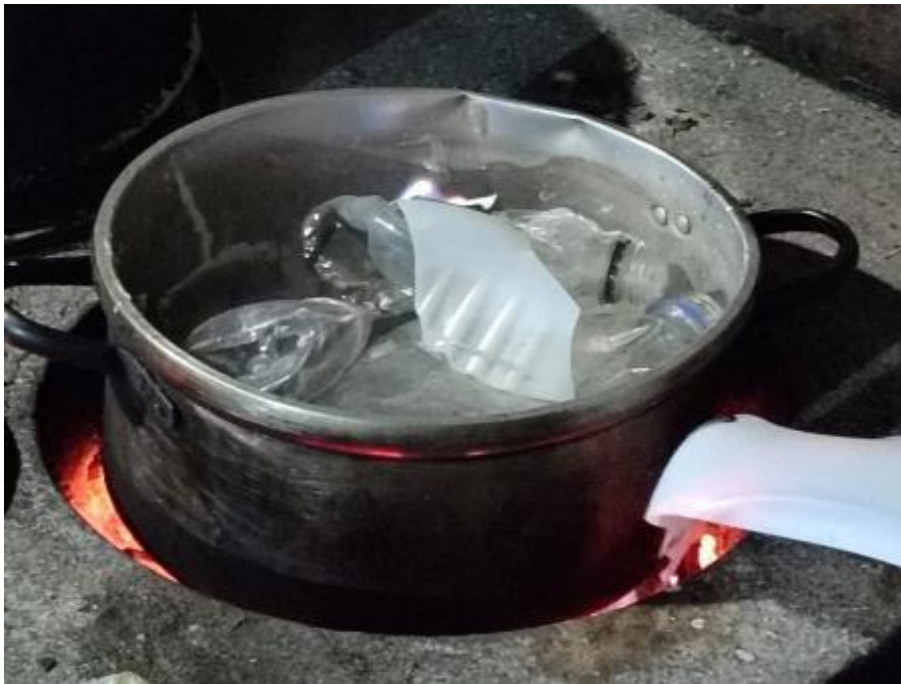
Foto 2: Olla y cocina para la fundición del plástico.
