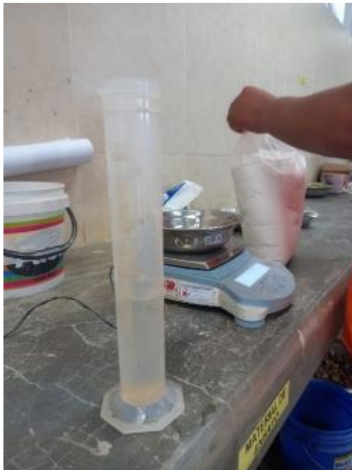
Foto 4: Probeta, balanza y deposito para los materiales.
