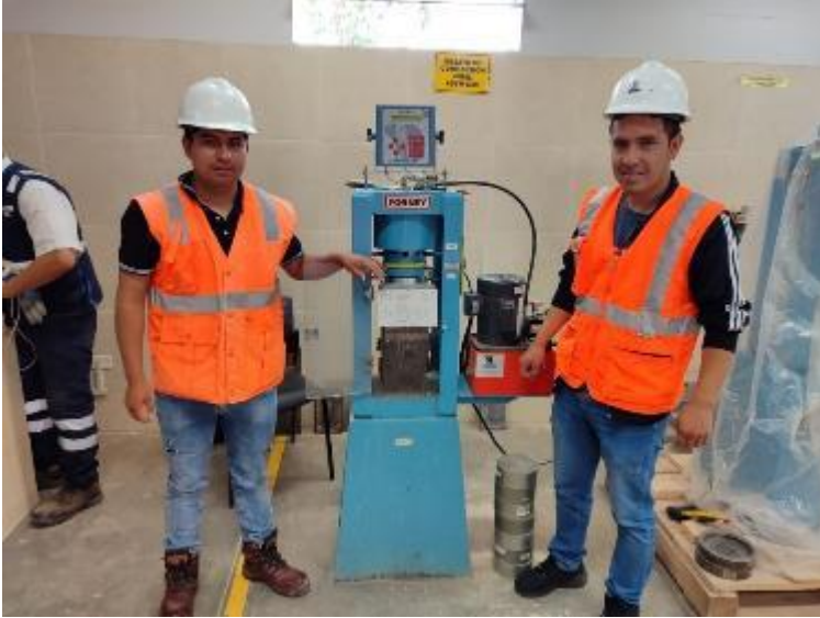
Foto 15: Ensayo de resistencia a la compresión de la muestra de la dosificación 60%:40% a base de plástico fundido y arena.
