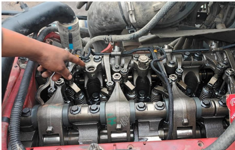
Figura 8: Mantenimiento Correctivo, calibración de motor
