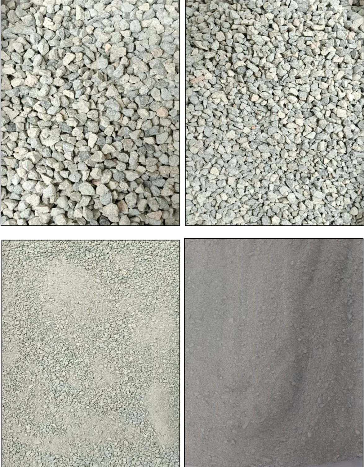
Imagen 13. Agregados a utilizar en los diseños de mezcla cantera Crushing
