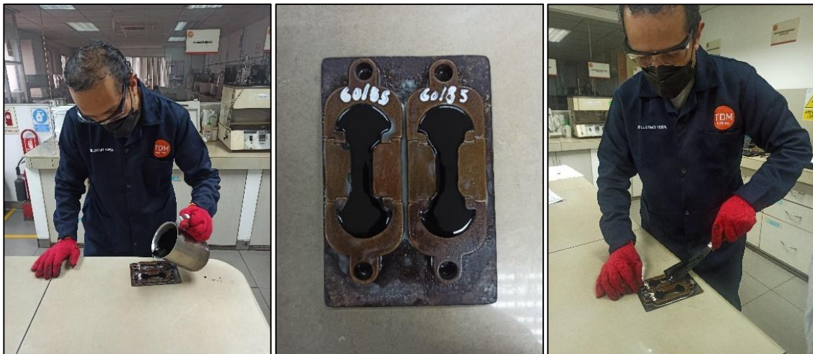
Imagen 23. Ensayo de recuperación elástica lineal
