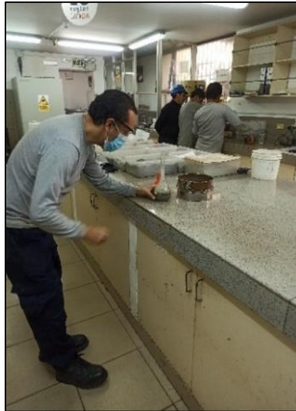
Imagen 17. Ensayo de gravedad específica de la arena
