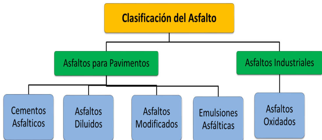
Imagen 3. Diagrama de clasificación del asfalto. Fuente: Elaboración propia.
