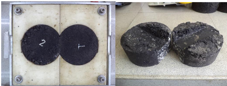
Imagen 36. Especímenes de prueba con mezcla asfáltica convencional.
