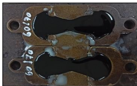
Imagen 22. Ensayo de ductilidad
