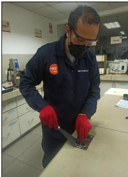
Imagen 21 Ensayo de punto de ablandamiento
