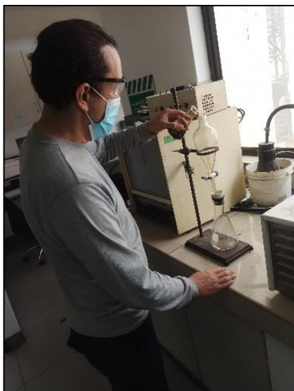
Imagen 20. Ensayo de solubilidad en tricloroetileno
