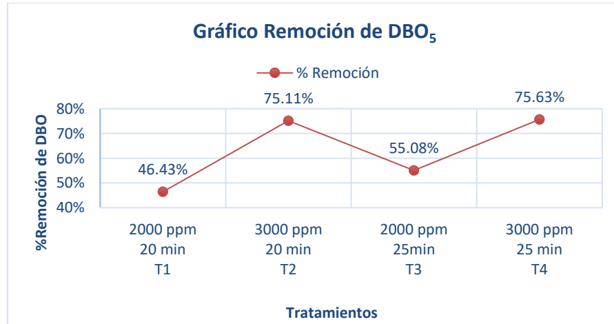
Figura 14: Remoción de DBO 5 a una concentración de 2000 ppm y 3000 ppm para un tiempo de floculación de 20 minutos y 25 minutos
