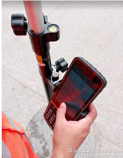
Controlador de GPS Diferencial
