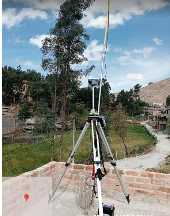
Posicionamiento de Base de GPS Diferencial
