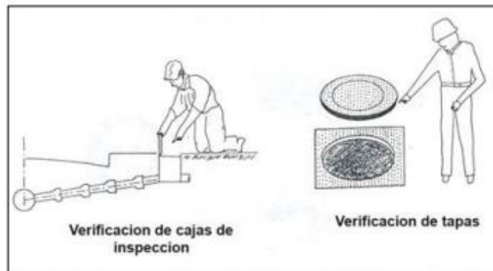
Figura 6 Verificación de Cajas de los Registros Domiciliarios y de las Tapas
