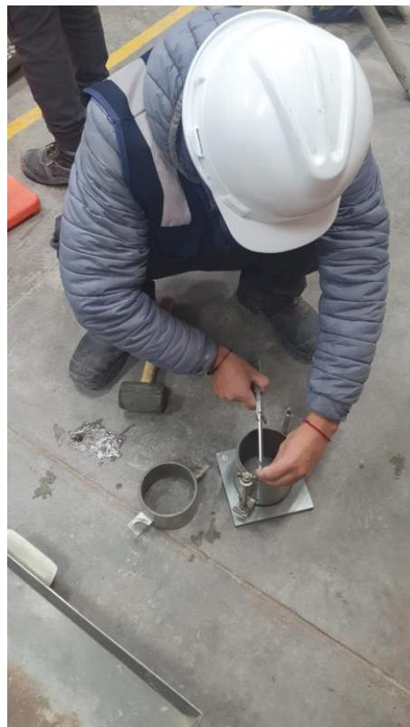
*Figura 85 Ensayo Proctor Modificado quinta capa de compactación*
