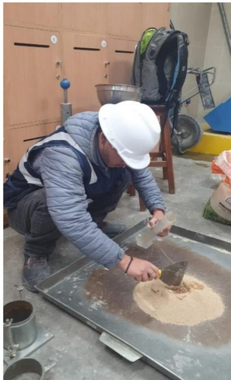
**Figura 6** *Ensayo Compactación muestra en molde*
