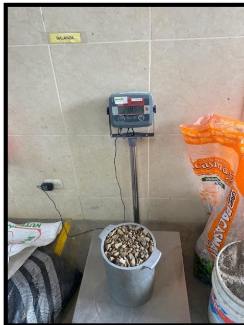
Peso de agregado grueso para ensayo de peso unitario del agregado grueso
