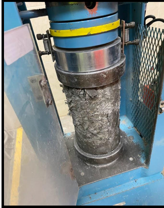
Especímen probeta de concreto con fibra de vidrio al 9% a los 7 días de curado.
