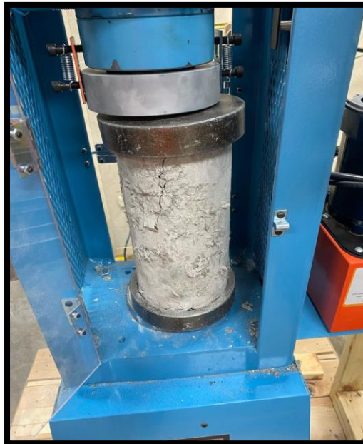
Probeta ensayada de concreto con fibra de vidrio al 5% a compresión axial a los 14 días de curado.
