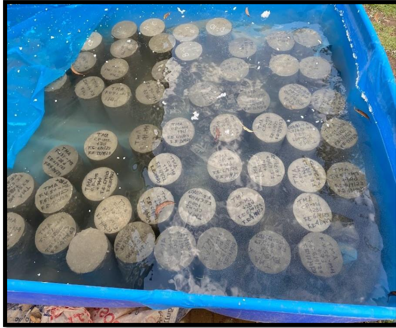
Curado de especímenes de concreto a temperatura de ambiente.
