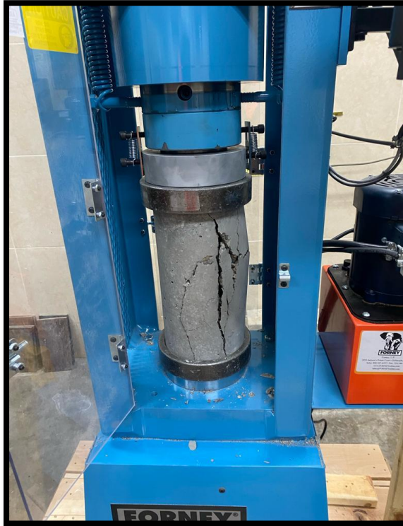
Probeta ensayada de concreto patrón a compresión axial a los 14 días de curado.
