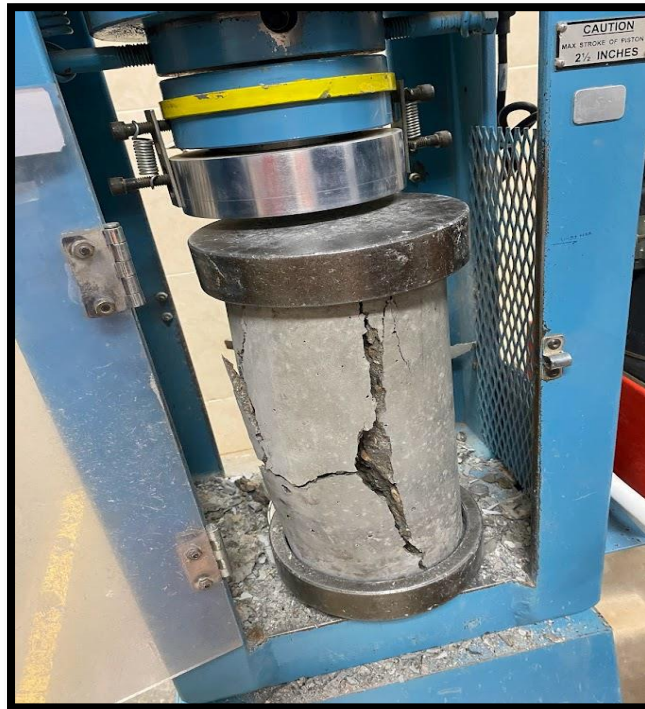
Probeta fracturada de concreto patrón, a la edad de los 7 días de curado.
