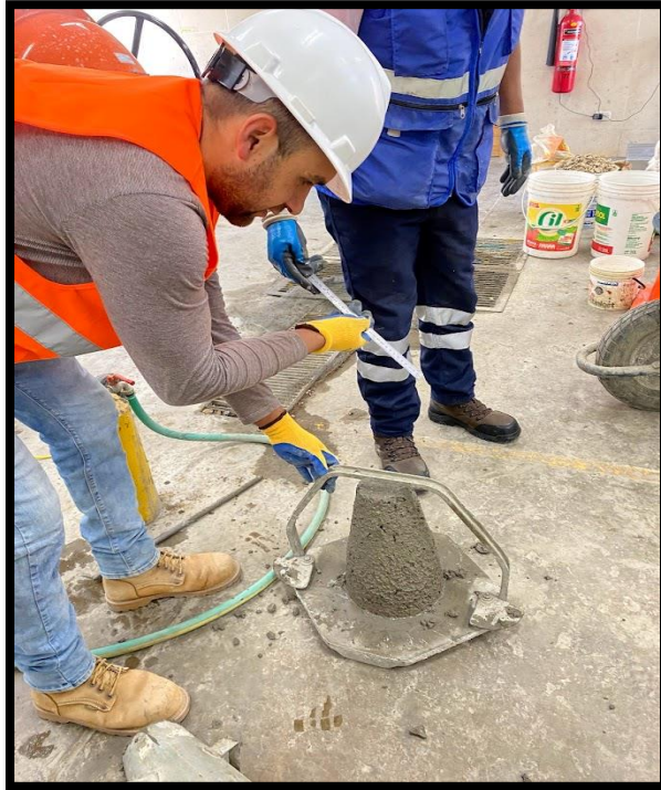
Medida de slump para concreto con fibra de vidrio al 7%.
