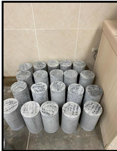
Especímenes cilíndricos de concreto patrón y concreto con fibra de vidrio al 5%, 7% y 9% para ensayo de compresión axial a los 14 días de edad (20 unidades).
