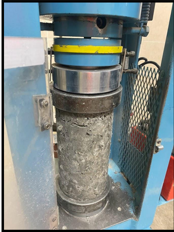
Espécimen probeta de concreto con fibra de vidrio al 5% a los 7 días de curado.
