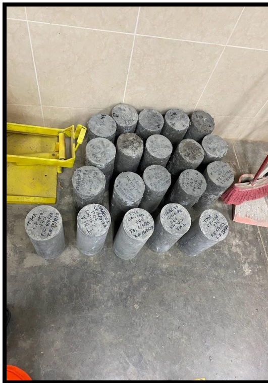
Especímenes de concreto patrón y concreto con fibra de vidrio al 5% ,7% y 9% para ensayo de compresión axial a los 7 días de curado (20 unidades).
