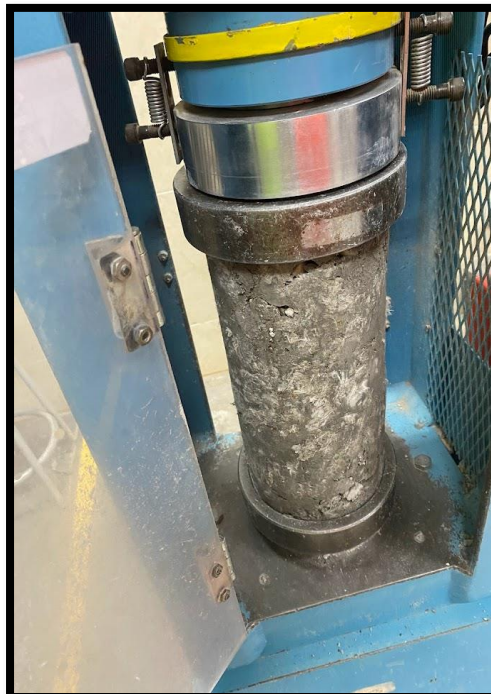
Espécimen probeta de concreto con fibra de vidrio al 7% a los 7 días de curado.
