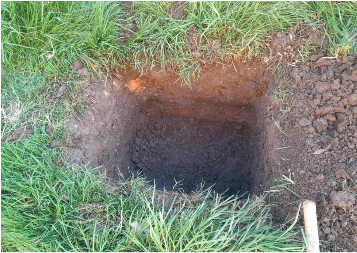
Nota: Excavación y extracción de muestra de la calicata 2 – km 03+160.
