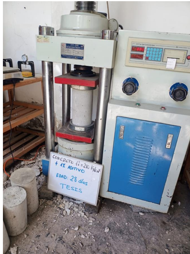
Toma de resultados de espécimen con 1% aditivo a los 28 días
