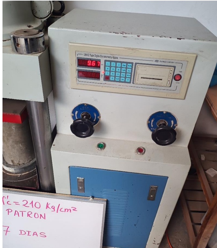
Toma de resultados de espécimen patrón de aditivo a los 7 días
