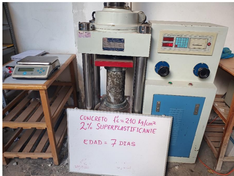
Toma de resultados de espécimen con 2% de aditivo a los 7 días
