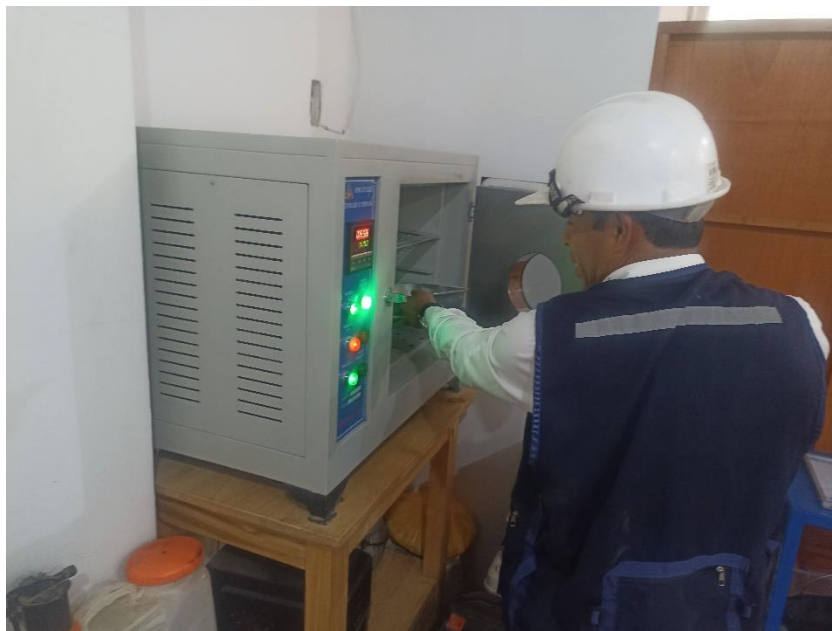
Ensayo de contenido de humedad
