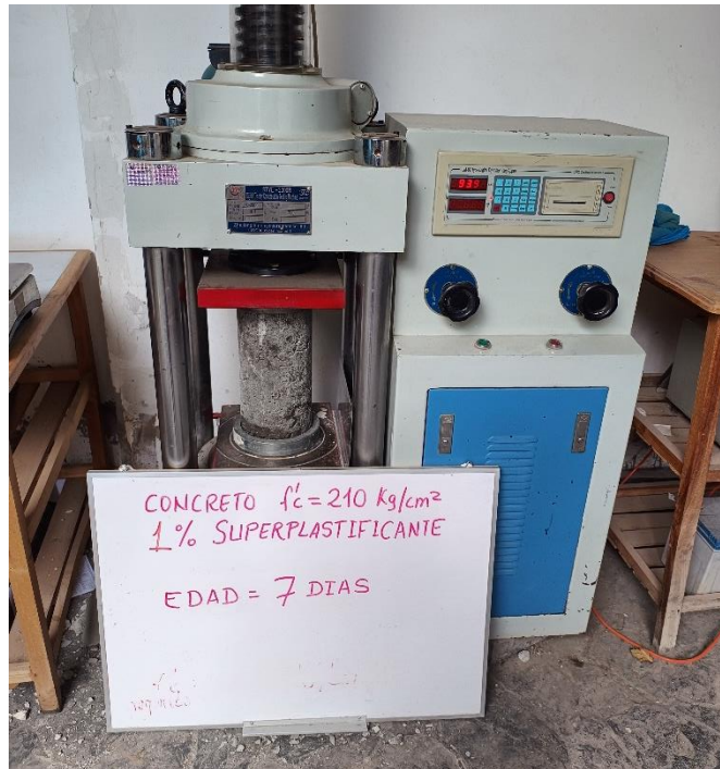
Toma de resultados de espécimen con 1% de aditivo a los 7 días
