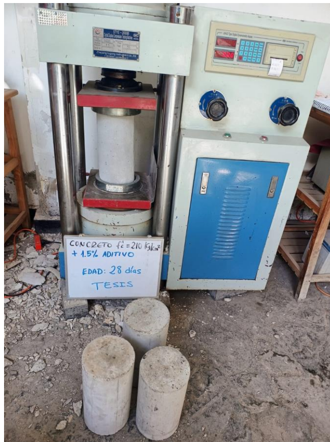
Toma de resultados de espécimen con 1.5% aditivo a los 28 días
