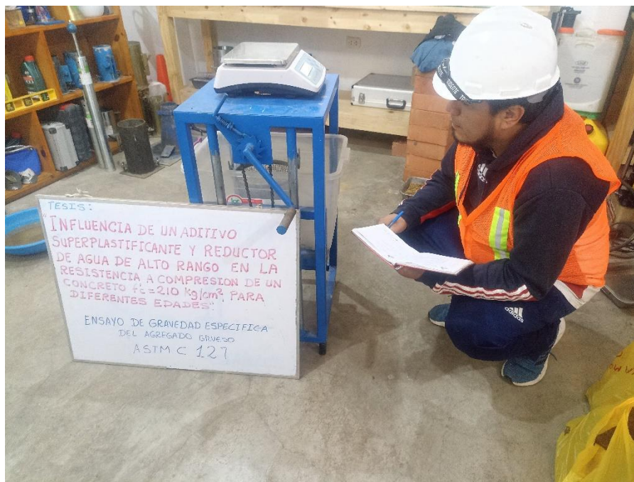
Ensayo de gravedad especifica del agregado grueso
