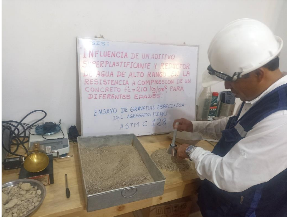
Ensayo de gravedad especifica del agregado fino
