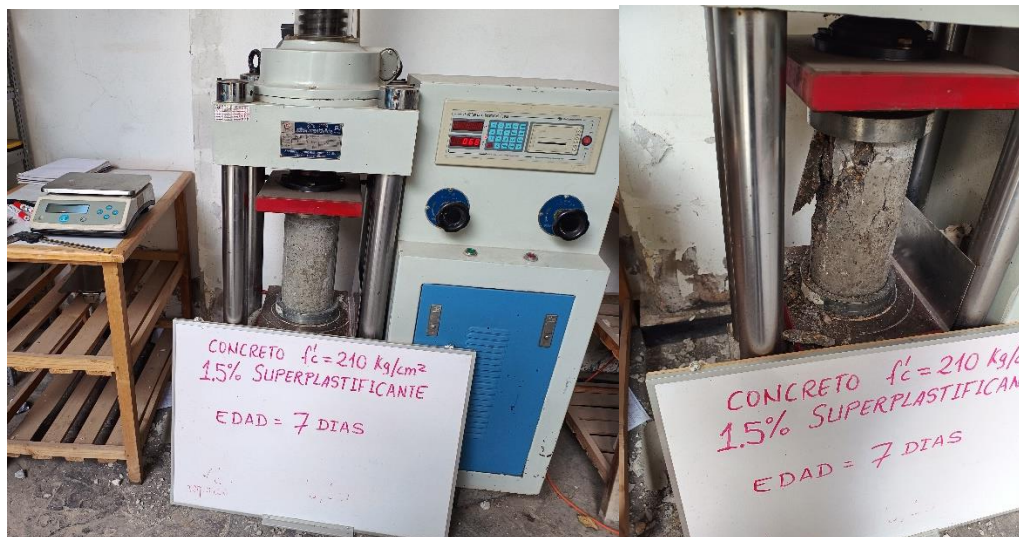
Toma de resultados de espécimen con 1.5% de aditivo a los 7 días
