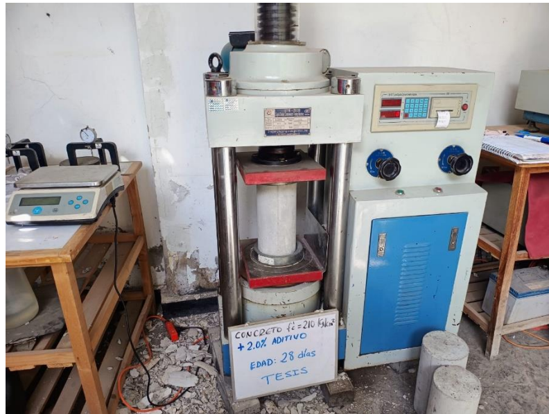
Toma de resultados de espécimen con 2% aditivo a los 28 días
