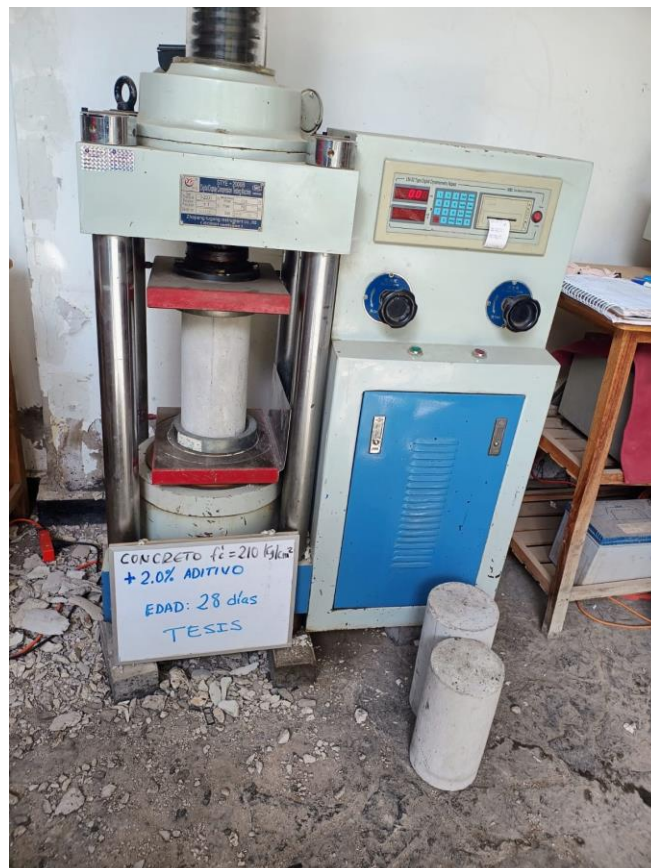
Toma de resultados de espécimen con 2% aditivo a los 28 días
