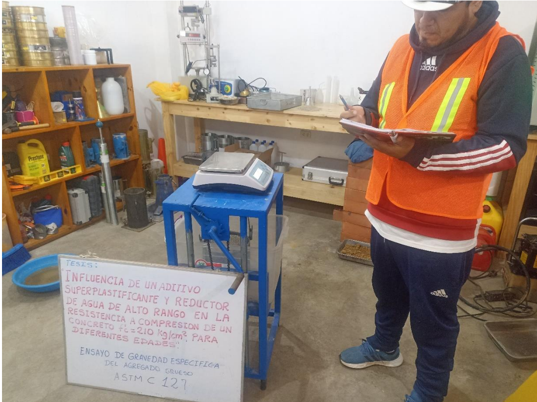
Ensayo de gravedad especifica del agregado grueso
