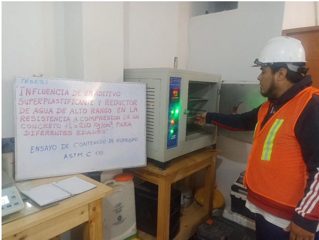
Ensayo de contenido de humedad
