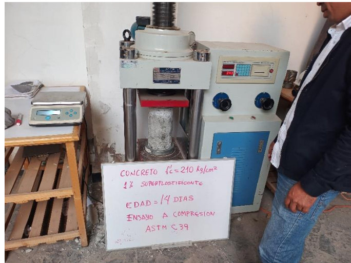
Toma de resultados de espécimen con 1% de aditivo a los 14 días
