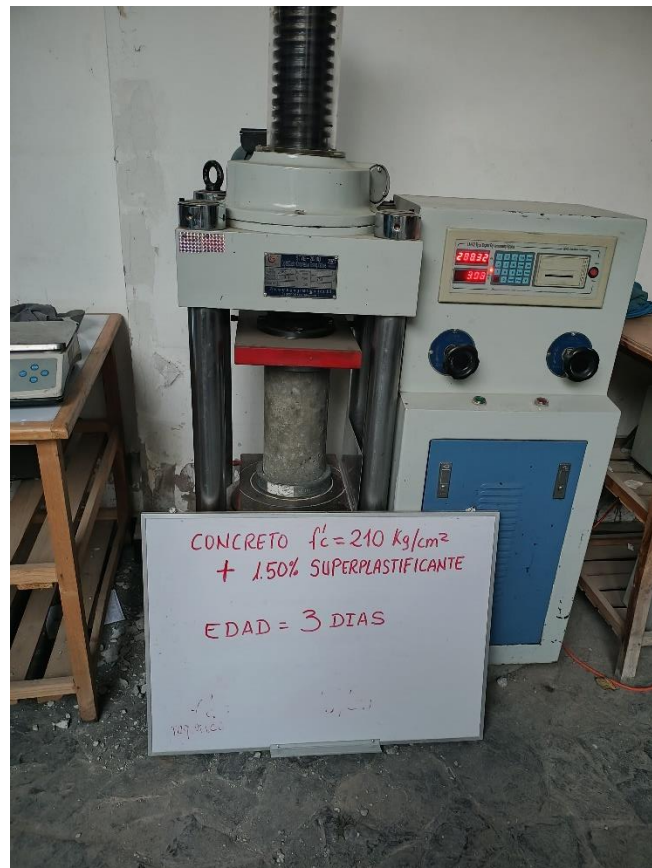
Toma de resultados de espécimen con 2% de aditivo a los 3 días
