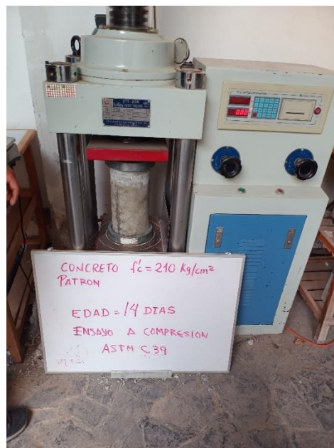
Toma de resultados a los 14 días, ensayo patron
