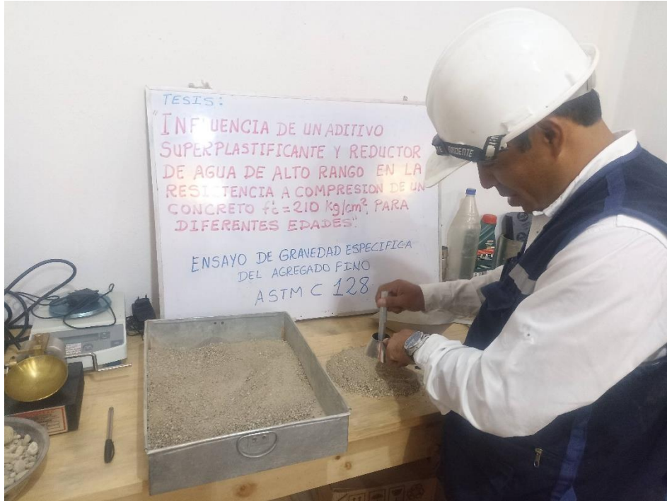
Ensayo de gravedad especifica del agregado fino
