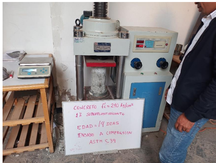
Toma de resultados a los 14 días, ensayo 1.0%
