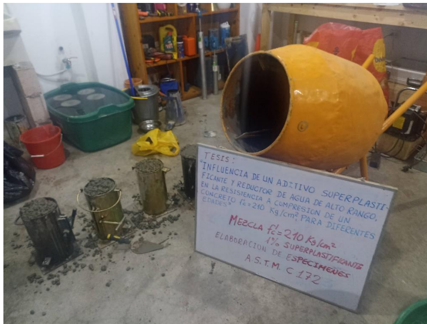
Elaboración de espécimen 1% de aditivo
