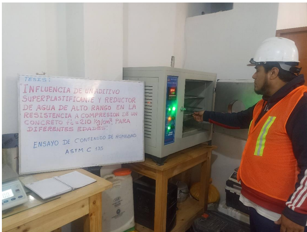
Ensayo de contenido de humedad
