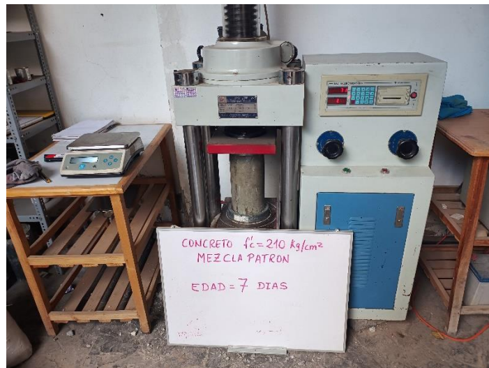
Toma de resultados de espécimen patrón de aditivo a los 7 días
