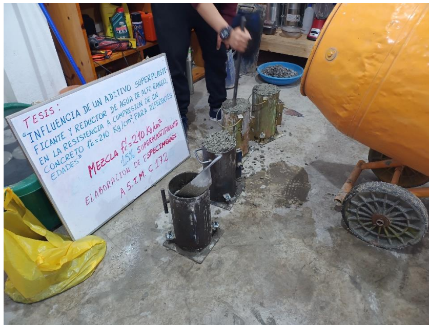
Elaboración de espécimen 1.5% de aditivo
