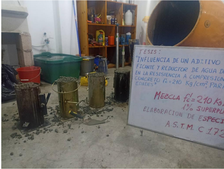
Elaboración de espécimen 1% de aditivo
