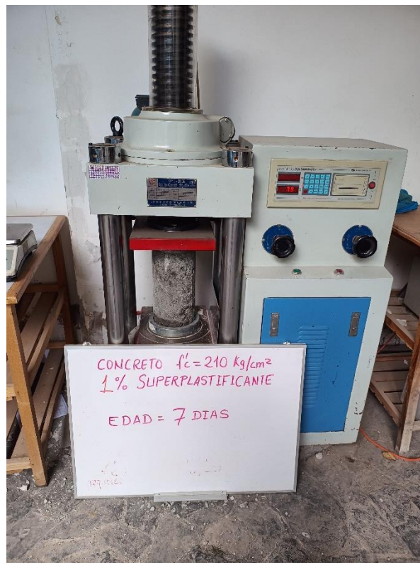
Toma de resultados de espécimen con 1% de aditivo a los 7 días
