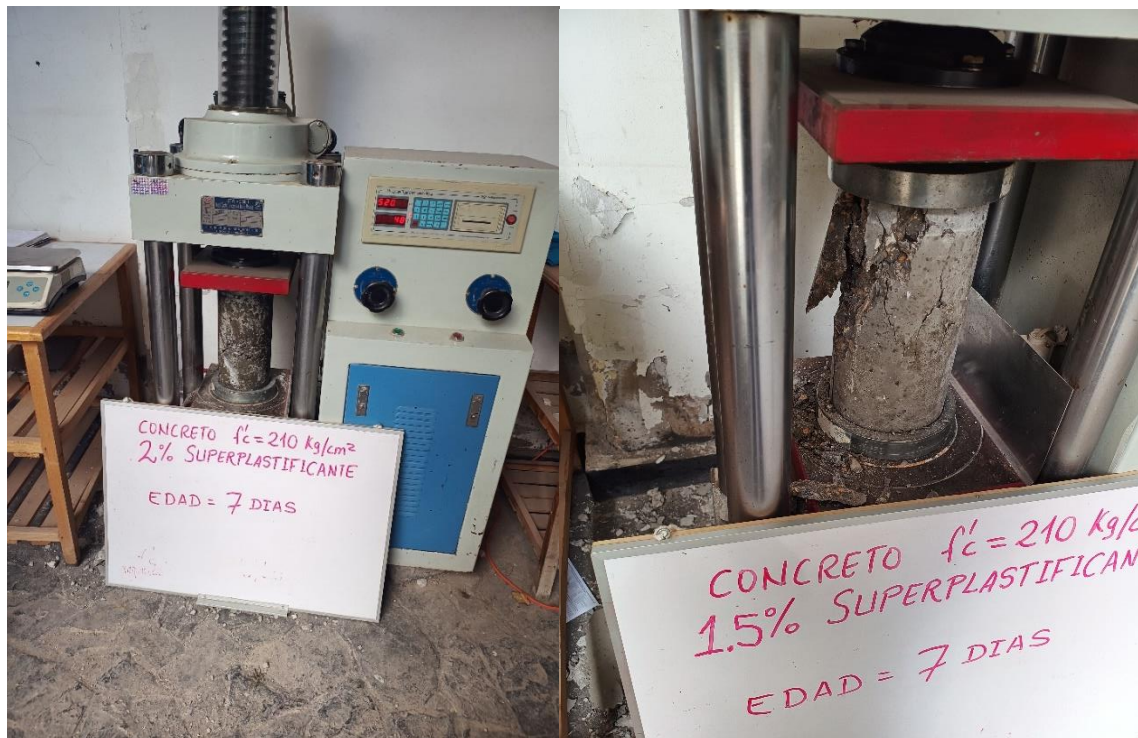
Toma de resultados de espécimen con 2% de aditivo a los 7 días
