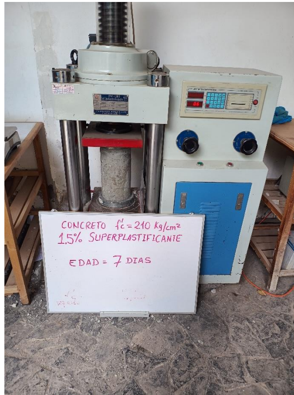
Toma de resultados de espécimen con 1.5% de aditivo a los 7 días
