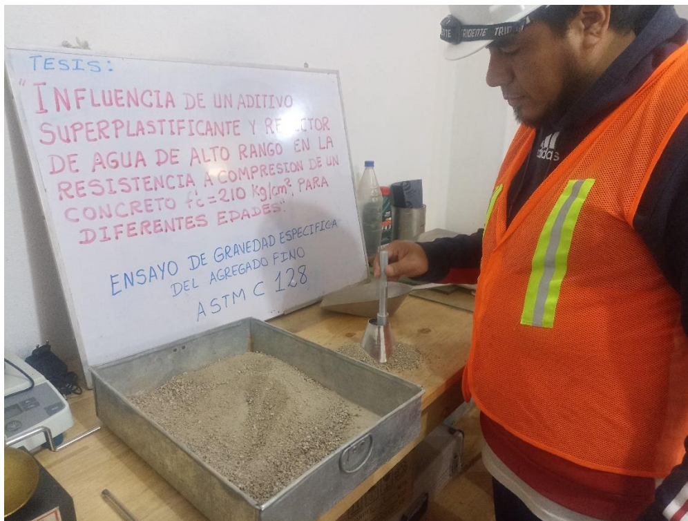
Ensayo de gravedad especifica del agregado fino
