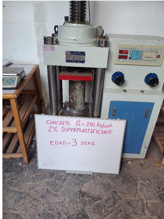
Toma de resultados de espécimen con 2% de aditivo a los 3 días
