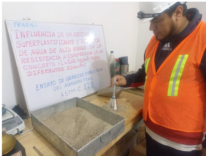
Ensayo de gravedad especifica del agregado fino
