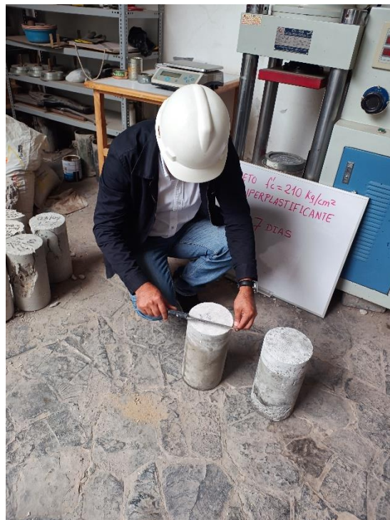
Toma de resultados a los 07 días, ensayo 1.0%
