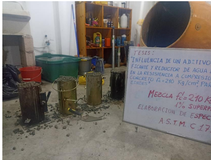
Elaboración de espécimen 1% de aditivo
