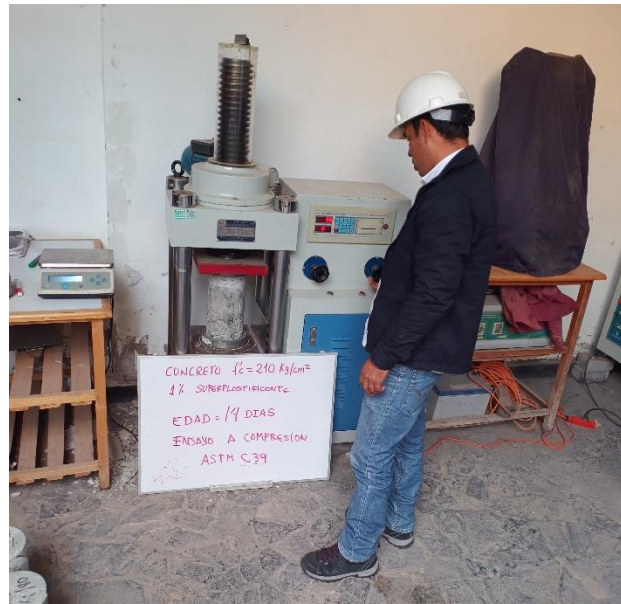
Toma de resultados a los 14 días, ensayo 1.0%
