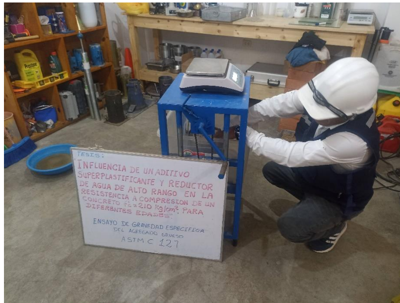
Ensayo de gravedad especifica del agregado grueso
