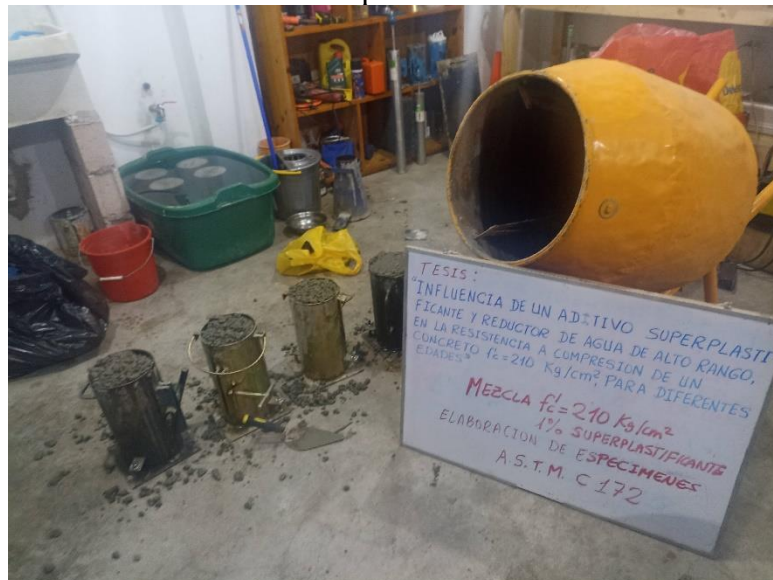
Elaboración de espécimen 1% de aditivo
