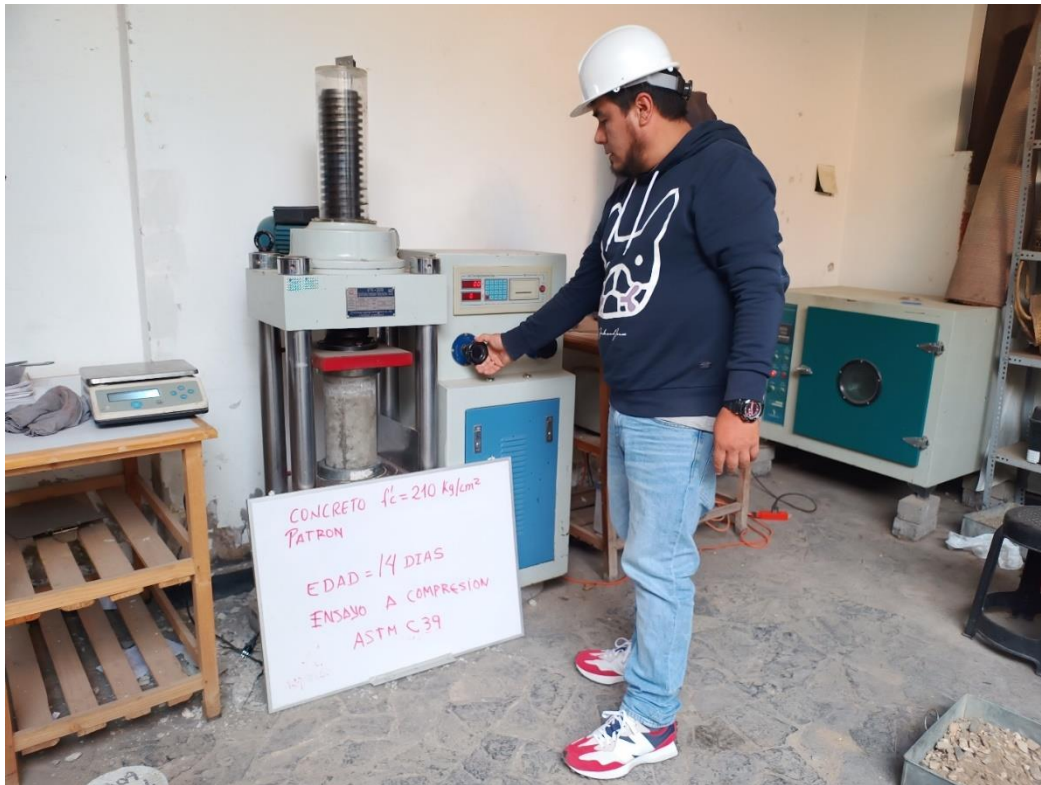
Toma de resultados a los 14 días, ensayo patrón
