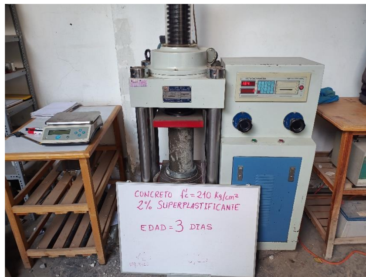
Toma de resultados de espécimen con 2% de aditivo a los 3 días
