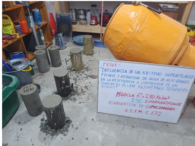
Elaboración de espécimen 2% de aditivo
