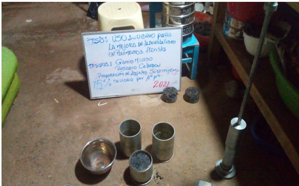
Foto 14. Preparación de Asfalto, sustituyendo 15% de agregado fino.
