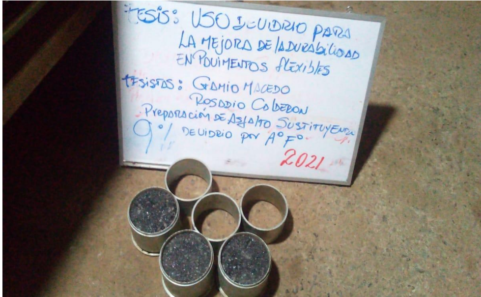
Foto 13. Preparación de Asfalto, sustituyendo 9% de agregado fino.
