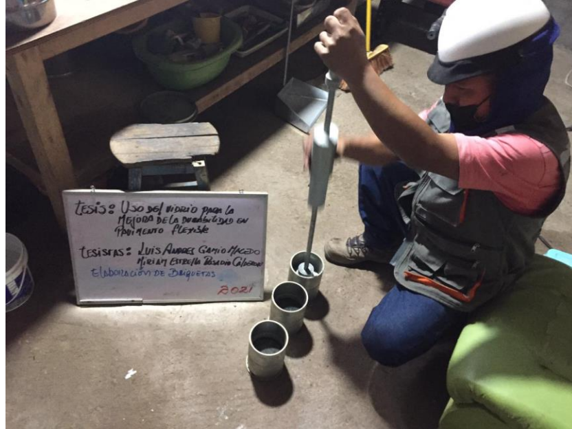
Foto 7. Elaboración de Briquetas.
