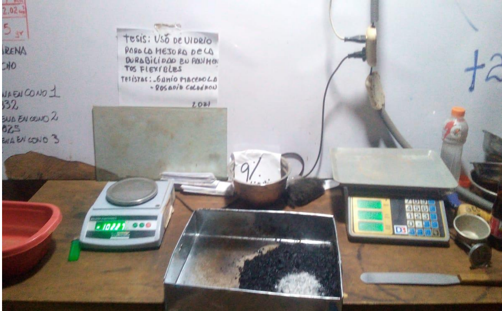
Foto 15. Insertando materiales a la mezcla asfáltica con 9% de vidrio molido.
