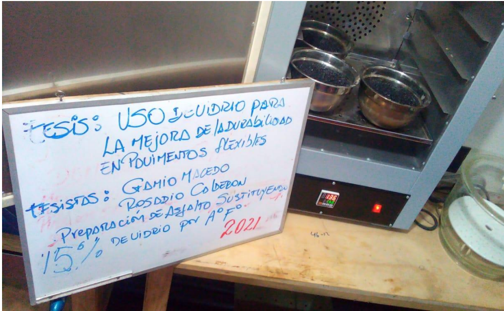
Foto 19. Preparación de asfalto sustituyendo el 15% de vidrio molido
