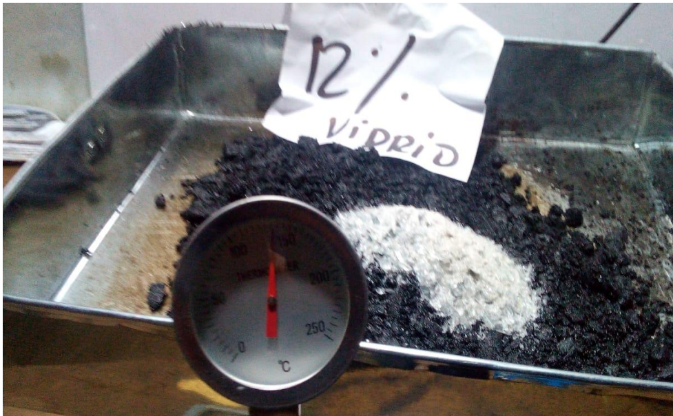
Foto 16. Insertando materiales a la mezcla asfáltica con 12% de vidrio molido.
