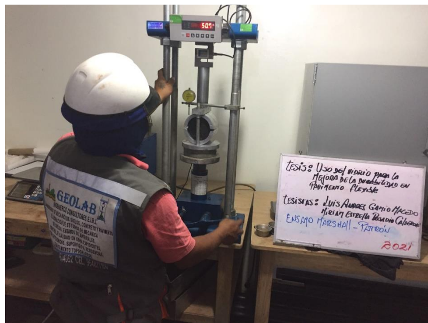
Foto 8. Ensayo Marshall – Patrón.
