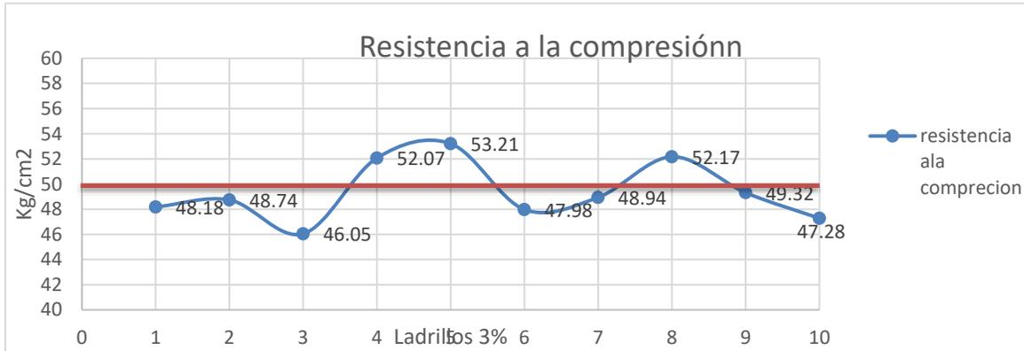
**Nota:** La línea roja determina el valor mínimo aceptado por la norma E0.70 de la resistencia a la compresión
