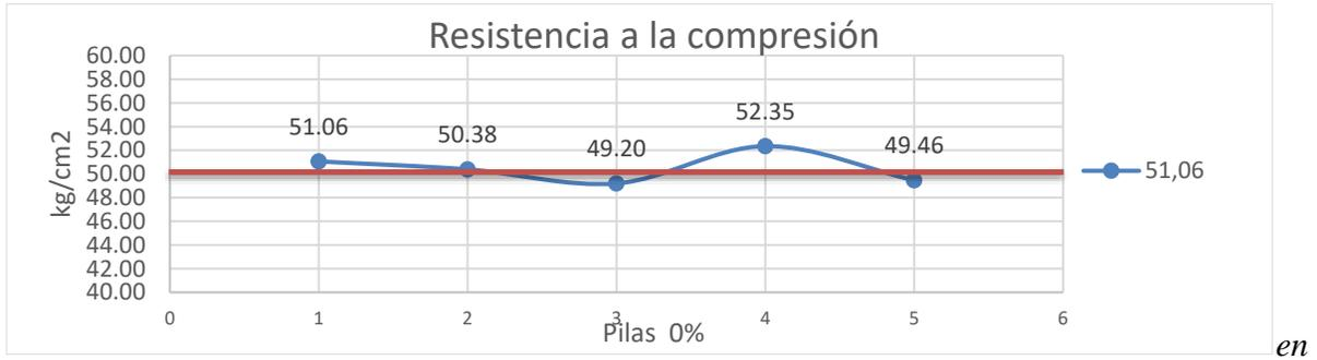
**Nota:** La línea roja determina el valor mínimo aceptado por la norma E0.70 de la resistencia a la compresión
