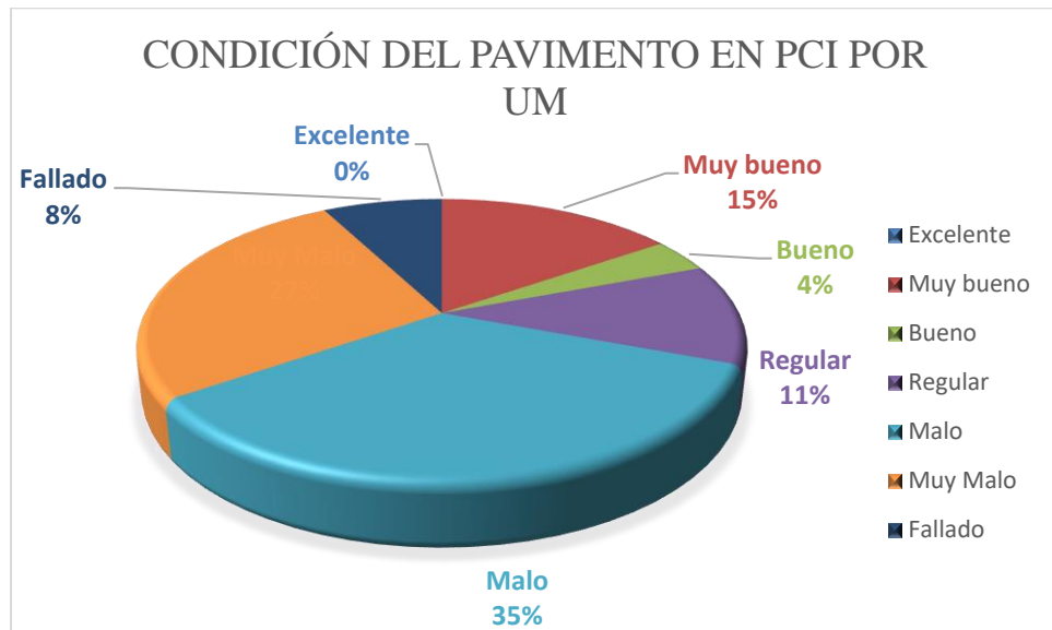
Figura 27 Condición del pavimento en PCI por UM
