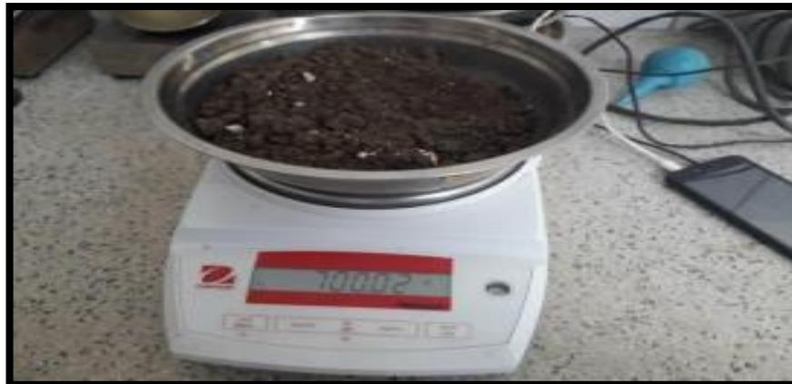
*Figura 17: Muestra del suelo empleado para el ensayo de granulometría
