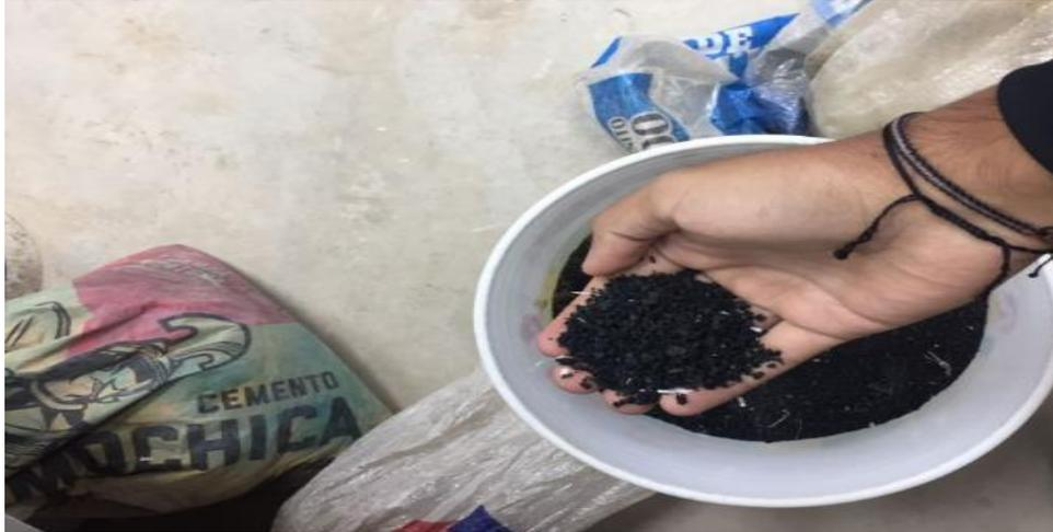
*Figura 57: Triturado de caucho de neumáticos de autos*
