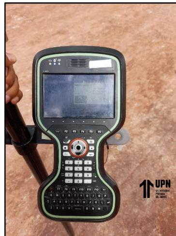
*Nota.* coleccionadora táctil con toda la información que va tomando el topógrafo en tiempo real, dicho colector esta emparejado con la base instalada en el punto CUS13205.
