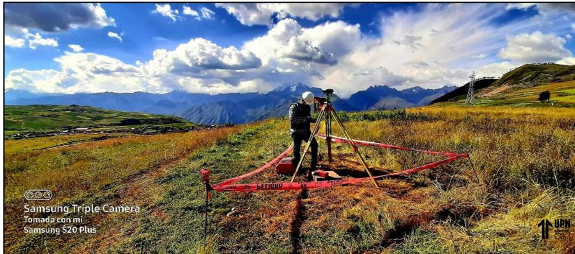
*Nota.* instalación de la base GPS en un punto geodésico certificado
