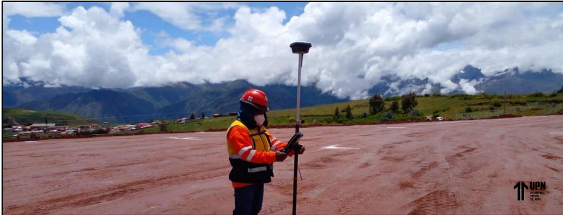
*Nota.* topógrafo tomando los registros en el eje del área de la muestra debidamente trazada, dicho Rover está conectada a una base geodésica
