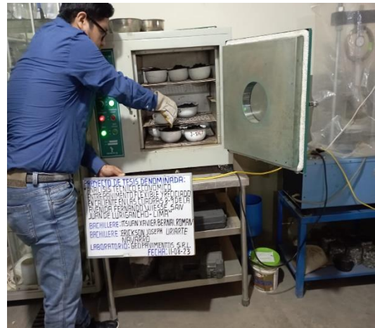
Colocación de la mezcla asfáltica al horno
