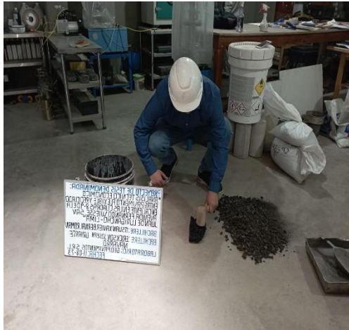
Fractura y trituración de pavimento recuperado
