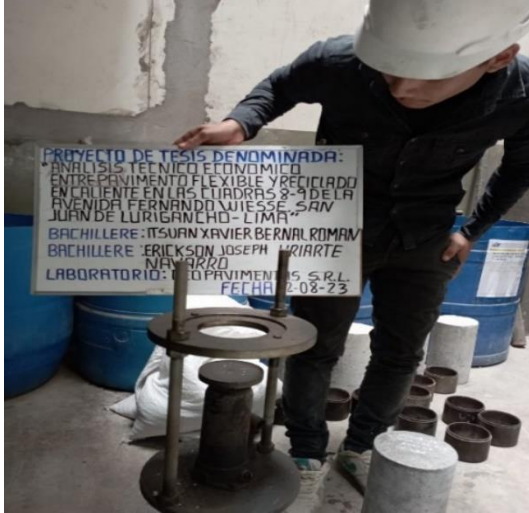
Utilización de extractor de probetas
