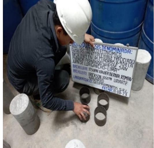
Separación del molde de compactación
