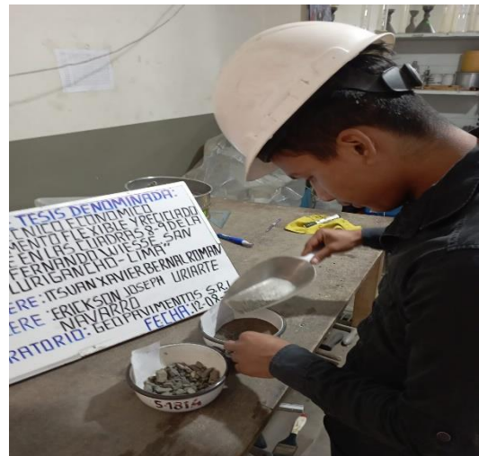
Separación del material grueso y fino
