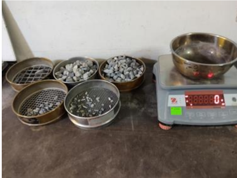
Fotografía N° 8: Cálculo del peso unitario suelto del agregado fino y agregado grueso.
