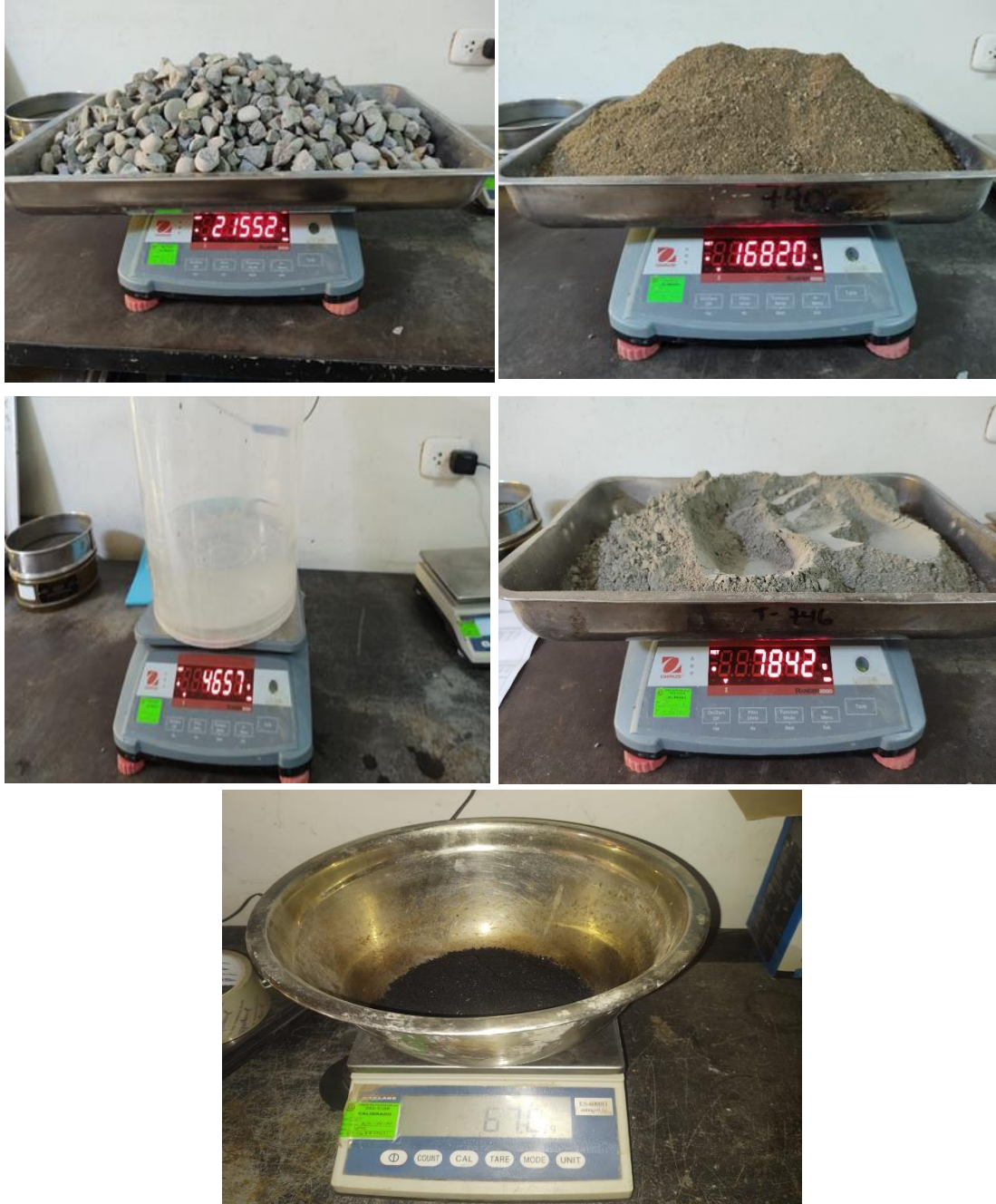
Fotografía N° 14: Peso de los agregados de acuerdo a las tandas de diseño y ceniza de bagazo de caña de azúcar CBCA.
