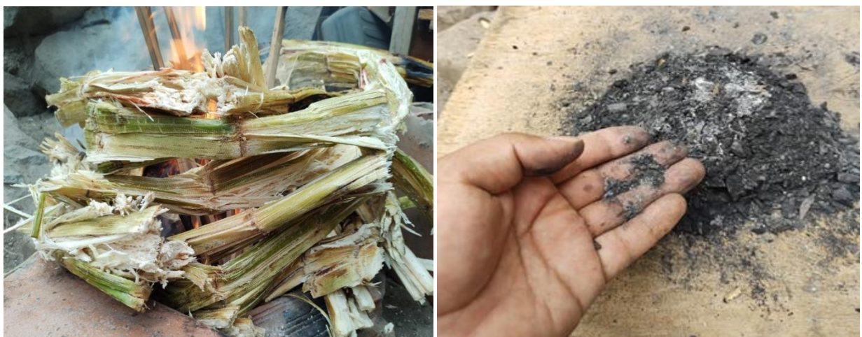
Fotografía N° 12: Calcinación del bagazo de caña de azúcar una vez secado.
