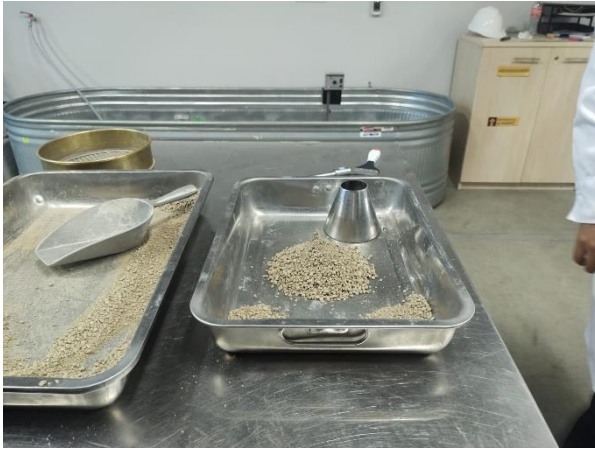
Fotografía N° 9: Ensayo de muestra saturada superficialmente seca y fiola de vidrio para ensayo de peso específico de agregado fino.
