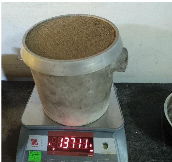
Fotografía N° 8: Cálculo del peso unitario suelto del agregado fino y agregado grueso.
