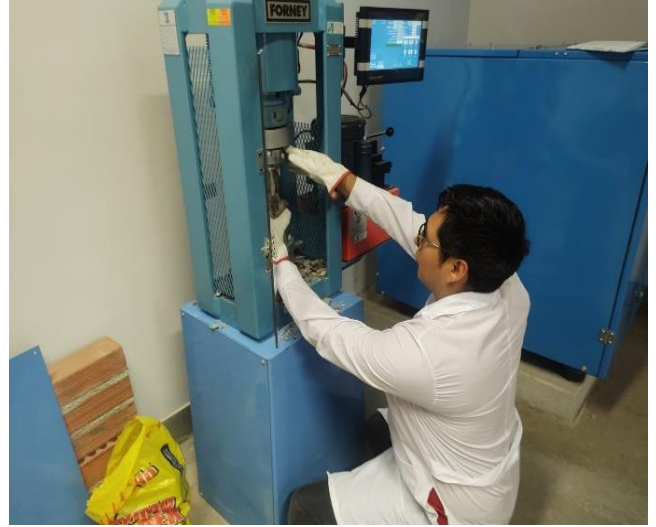
Fotografía N° 17: Ensayo de resistencia a la compresión de especímenes de concreto en el laboratorio, de acuerdo a la norma ASTM C 39-18 / NTP 339.034
