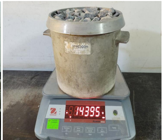
Fotografía N° 8: Cálculo del peso unitario suelto del agregado fino y agregado grueso.
