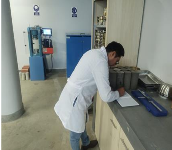
Fotografía N° 17: Ensayo de resistencia a la compresión de especímenes de concreto en el laboratorio, de acuerdo a la norma ASTM C 39-18 / NTP 339.034
