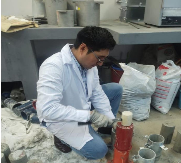
Fotografía N° 16: Desmolde de especímenes de concreto y colocación de especímenes en la poza de curado.
