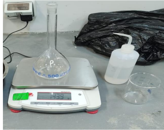
Fotografía N° 9: Ensayo de muestra saturada superficialmente seca y fiola de vidrio para ensayo de peso específico de agregado fino.
