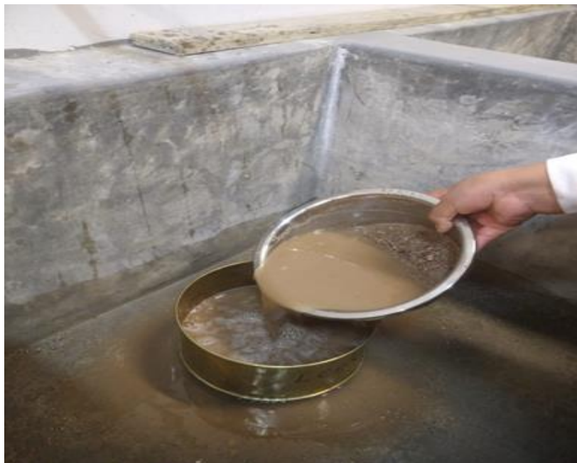
Fotografía N° 4: Agregado fino en lavado de malla N° 200.
