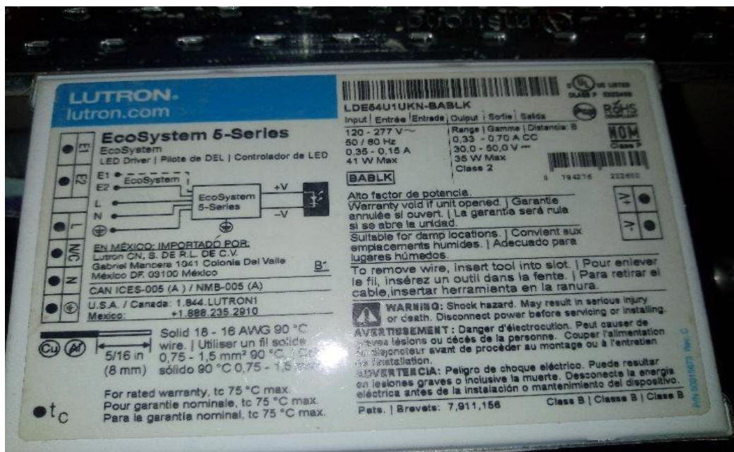
Balastros electrónicos utilizados para el sistema de control de Iluminación
