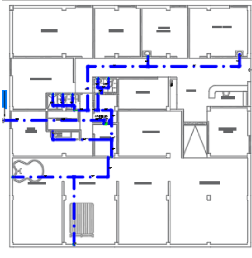
Figura 83. Distribución de desagüe, Bloque Médico. Elaboración propia.
