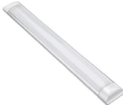
Figura 87. Luminaria para interiores. Model Le Lineal Adosado / sobrepuesto 36W 5000K 4000lm 802X102mm. Elaboración propia.
