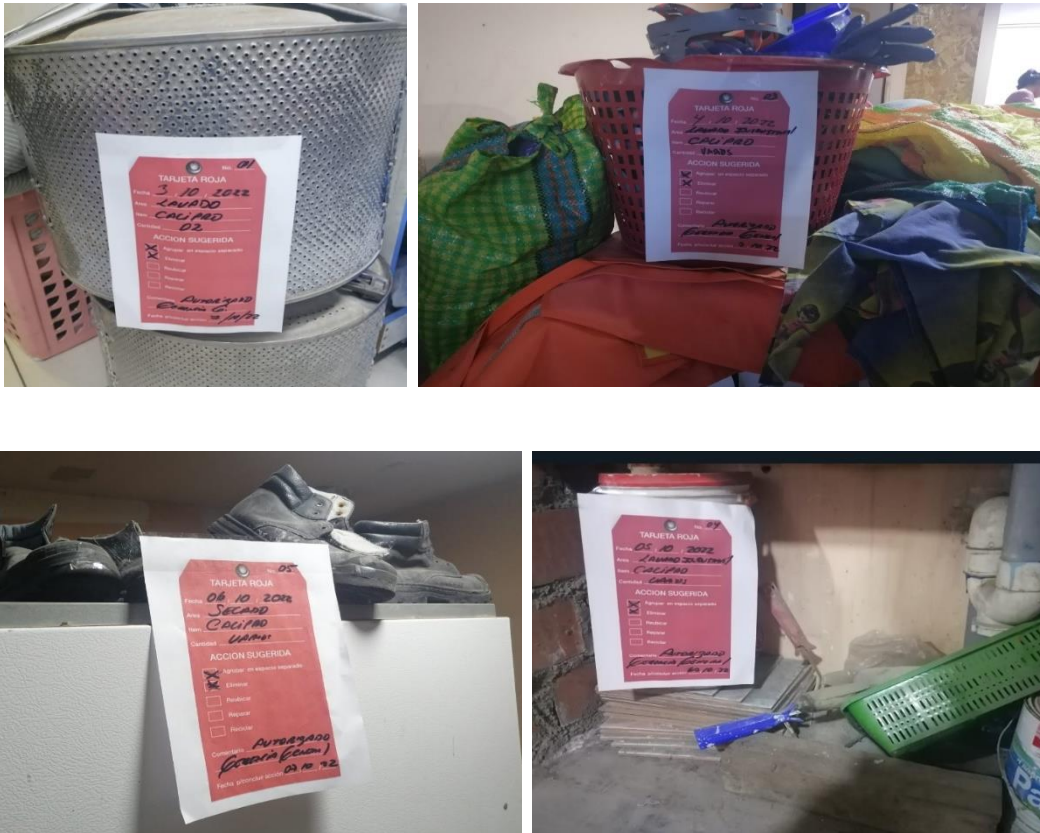
Figura 23 Identificación de elementos innecesarios en las áreas y Colocación de tarjetas rojas
