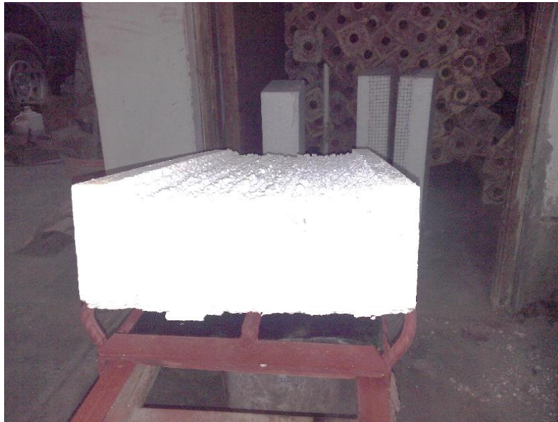
Figura 17: Rasgado de los casetones de poliestireno expandido de 1.5 cm de profundidad
