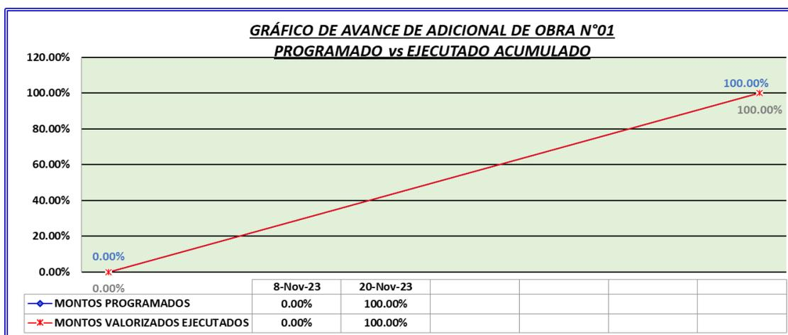
*Nota.* La Curva “S” muestra un comparativo entre el porcentaje de avance real acumulado y el programado de la ejecución de las partidas del adicional de obra N°01
