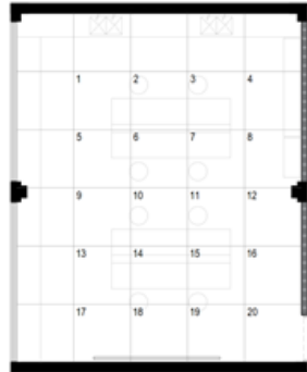
Figura 01: Grilla de puntos exponen resultados de niveles de iluminación del laboratorio propuesto. Propuesta "A".
