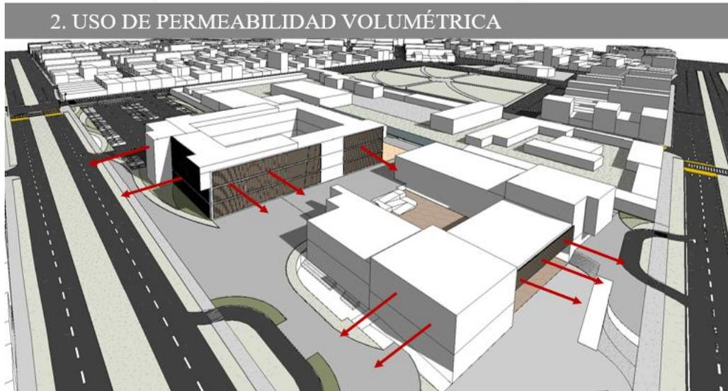
Sustracción de la volumetría generando patios, pasillos de tal manera que genere una permeabilidad visual desde el exterior al interior e igual con la aparición de grandes vanos de ventanas protegidos para generar visuales del interior al exterior.
