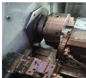
Ilustración 8: Colisión de gran magnitud torreta - husillo
