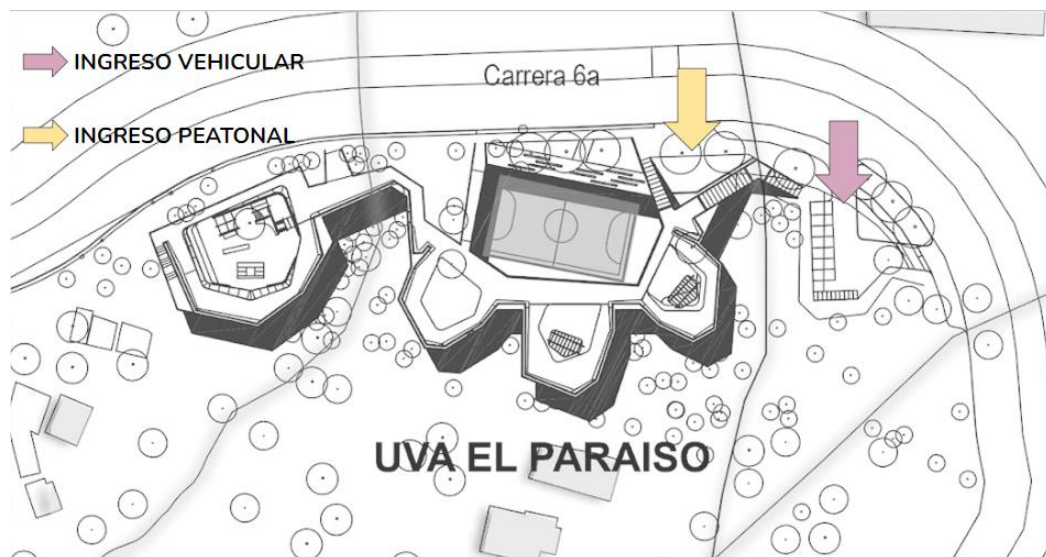
Figura N° 57 Accesos peatonales y vehiculares - La Uva el Paraíso.
