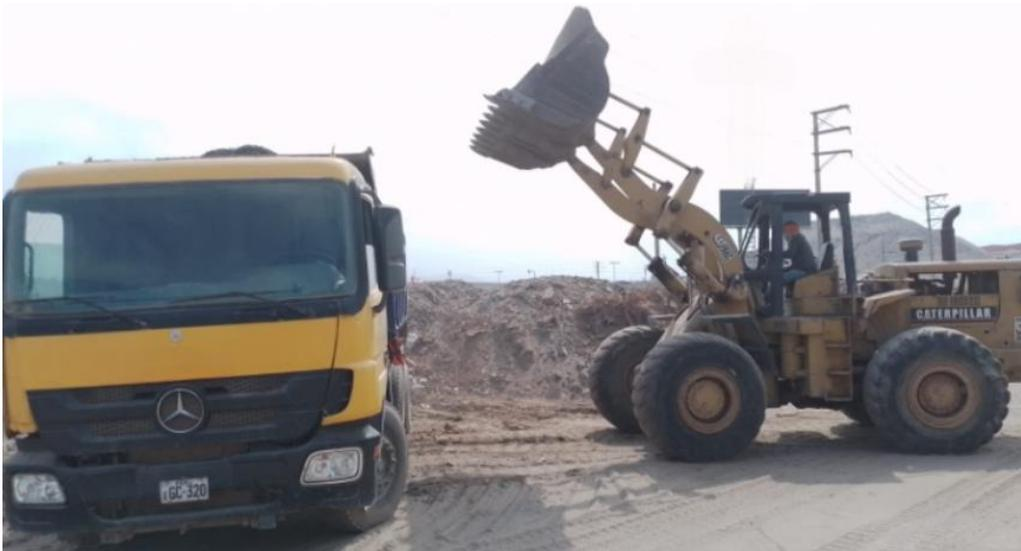
*Nota:* En la figura, se ve la retroexcavadora en actividad recogiendo los residuos de construcción y demolición con ayuda de un volquete.
