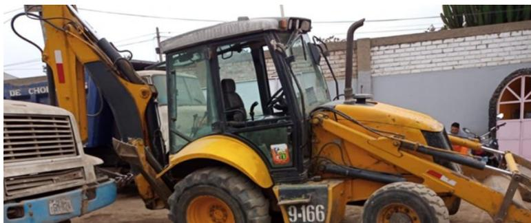
*Nota:* En la figura, se ve la retroexcavadora utilizada para transportar los residuos sólidos de construcción y demolición.
