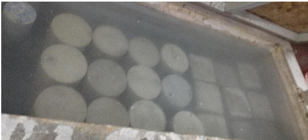
El curado de probetas de concreto es un proceso esencial que se lleva a cabo después de la fabricación de las muestras de concreto (probetas) y antes de realizar pruebas de resistencia, como pruebas de compresión. El propósito del curado es mantener el concreto en condiciones adecuadas de humedad y temperatura para que alcance su resistencia y durabilidad óptimas, para lo cual nos guiaremos de la norma ASTM C192.
