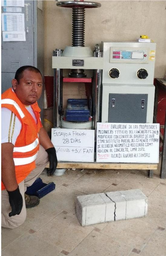
Los ensayos de resistencia a la flexión se realizaron en probetas de concreto prismáticas de 15 cm x 15 cm x una longitud de 54 cm, con 3 probetas por cada diseño a los 28 días, según la norma ASTM C78.
