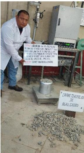
Para determinar el peso unitario del agregado grueso, se usará el ASTM C29 y comprende el siguiente procedimiento:
