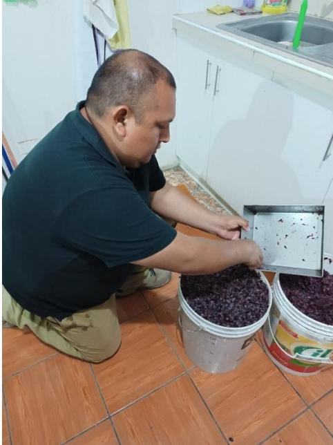
El bagazo de uva paso por varias fases para poder ser usado en el concreto, a continuación, detallamos esas fases:
