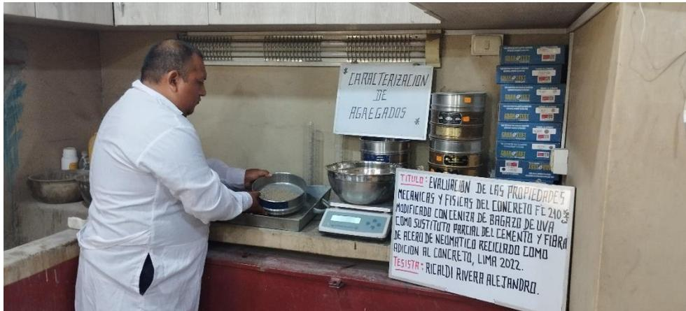
Se realizó el análisis de granulometría del agregado fino según la norma ASTM C 136, que se utiliza para determinar la distribución de tamaños de partículas en el agregado fino, generalmente arena, que se utilizará en la mezcla de concreto. Este análisis es fundamental para evaluar la calidad del agregado fino, para poder ver el detalle de los resultados se puede revisar el anexo 13.
