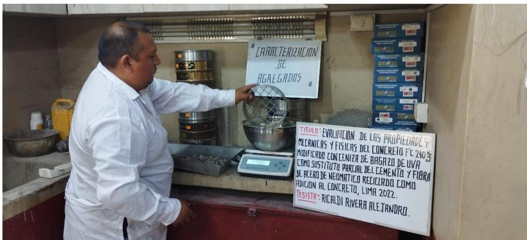
El análisis de granulometría de agregados gruesos se lleva a cabo siguiendo el estándar ASTM C136, este análisis se utiliza para determinar la distribución de tamaños de partículas en el
