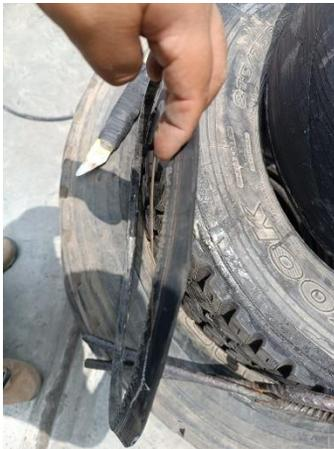
**Extracción Manual:** Con un alicate de presión, se engancha la fibra de acero expuesta y se tira de ella con firmeza para despegarla del caucho del neumático.
