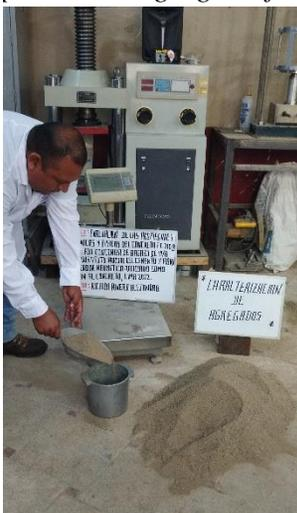
El proceso para determinar el peso unitario del agregado fino, según la norma ASTM C29, generalmente comprende el siguiente procedimiento:
