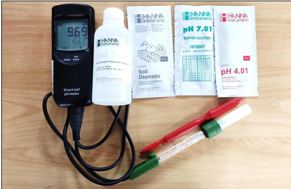
Nota. Medidor portátil de pH HI99121 - HANNA incluidas soluciones buffer.
