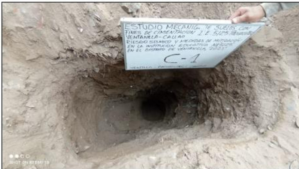
FOTO N° 4: Vista interior de la calicata C-1 donde se muestra el perfil estratigráfico del subsuelo. Se alcanzó una profundidad de exploración de 3.00m. No se encontró la presencia de nivel freático a dicha profundidad.
