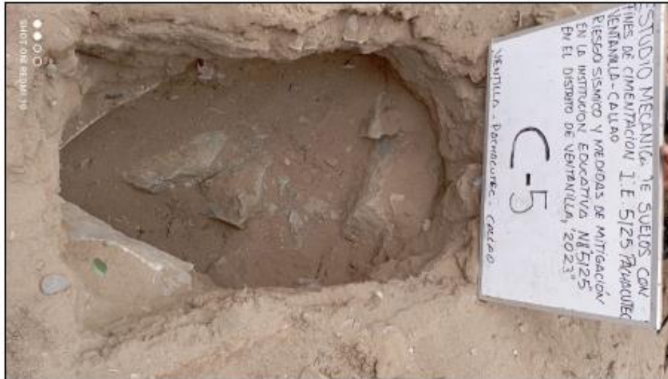
FOTO N° 19: Vista interior de la calicata C-5 donde se muestra el proceso de excavación y el perfil estratigráfico del subsuelo.
