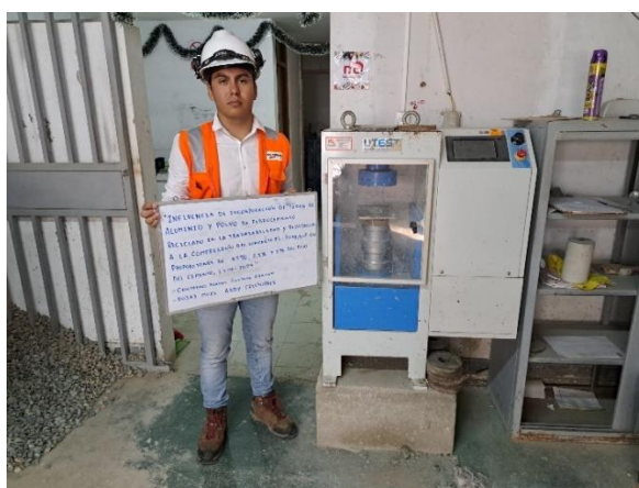
Máquina universal para realizar pruebas de rotura de probeta
