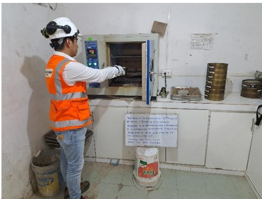
Introducción de los agregados en el horno.
