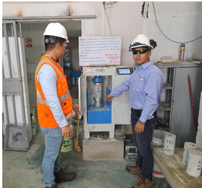
Rotura de probetas de concreto f'c=210 kg/cm 2 a los 28 días
