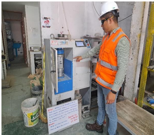
Rotura de probetas de concreto f'c=210 kg/cm 2 a los 7 días
