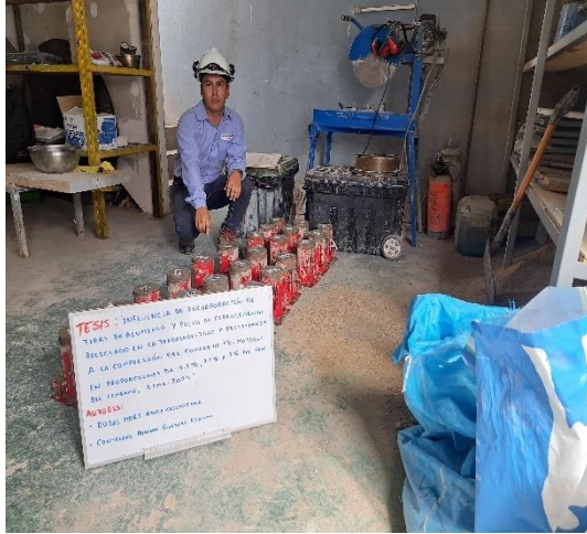
Elaboración de probetas de concreto
