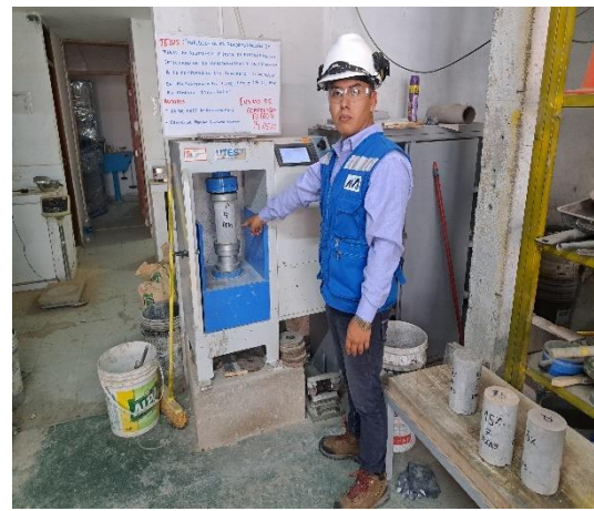
Rotura de las probetas de concreto con f'c=210 kg/cm a los 14 días.
