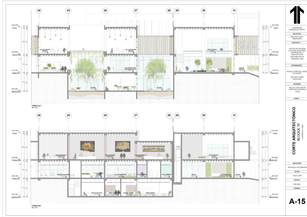
Cortes arquitectónicos del sector A-A
