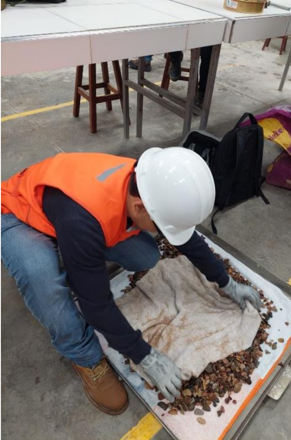
Figura 53 Secado de la muestra de agregado grueso
