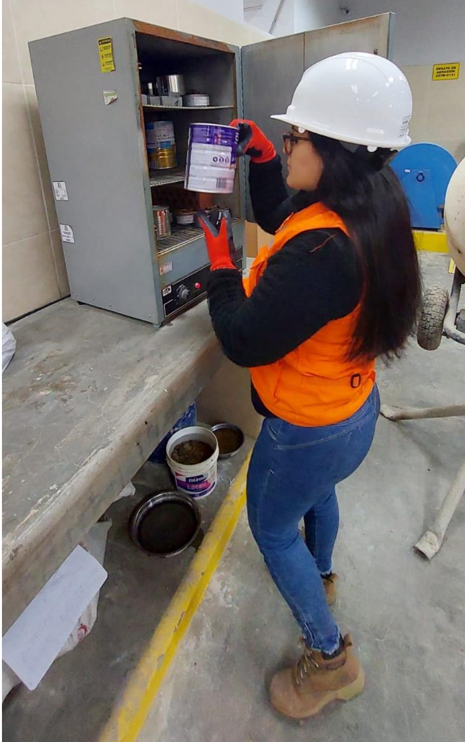
Figura 48 Colocación de agregado al horno para su posterior ensayo de granulometría por la tesista Lily
