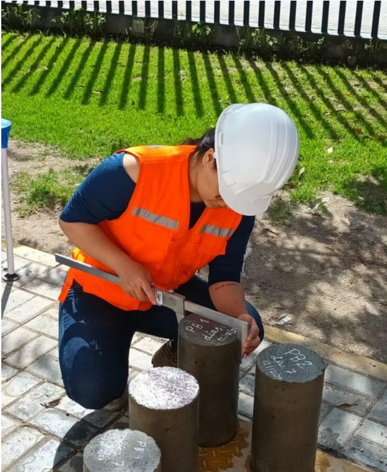
Figura 83 Medición de los testigos de concreto por la tesista Lily
