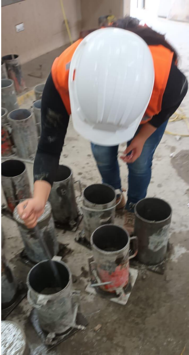
Figura 73 Chuzado de concreto en las probetas
