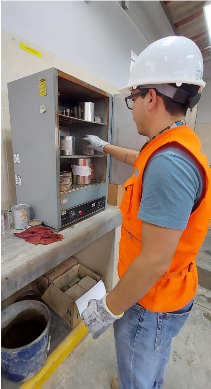
Figura 57 Colocación de agregado al horno para su posterior ensayo de peso suelto y unitario por el tesista Diego
