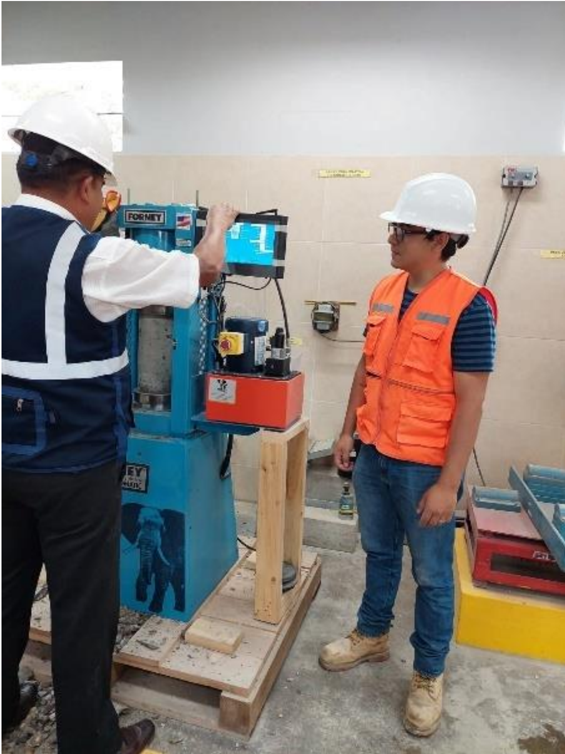
Figura 85 Prueba de resistencia a la compresión 2
