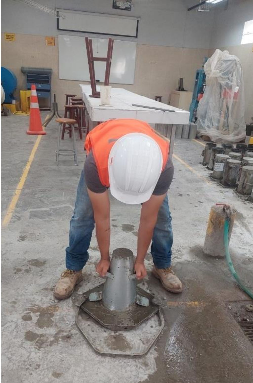
Figura 68 Levantado del cono de Abrahams
