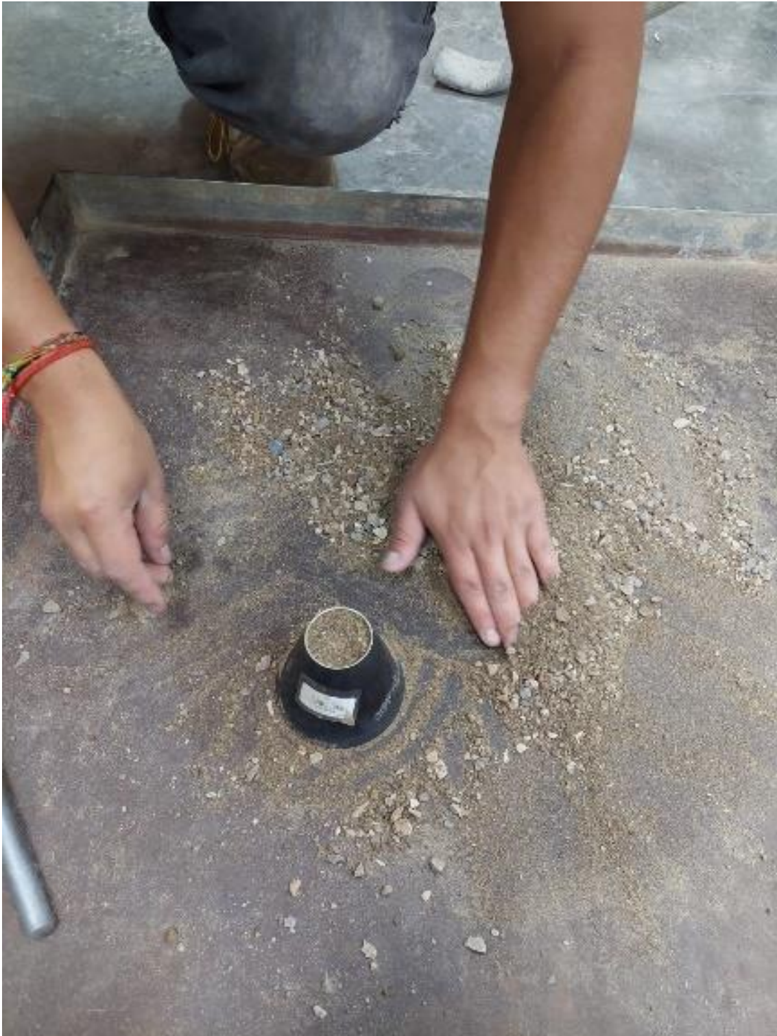
Figura 54 Compactado de agregado fino para el ensayo del molde cónico
