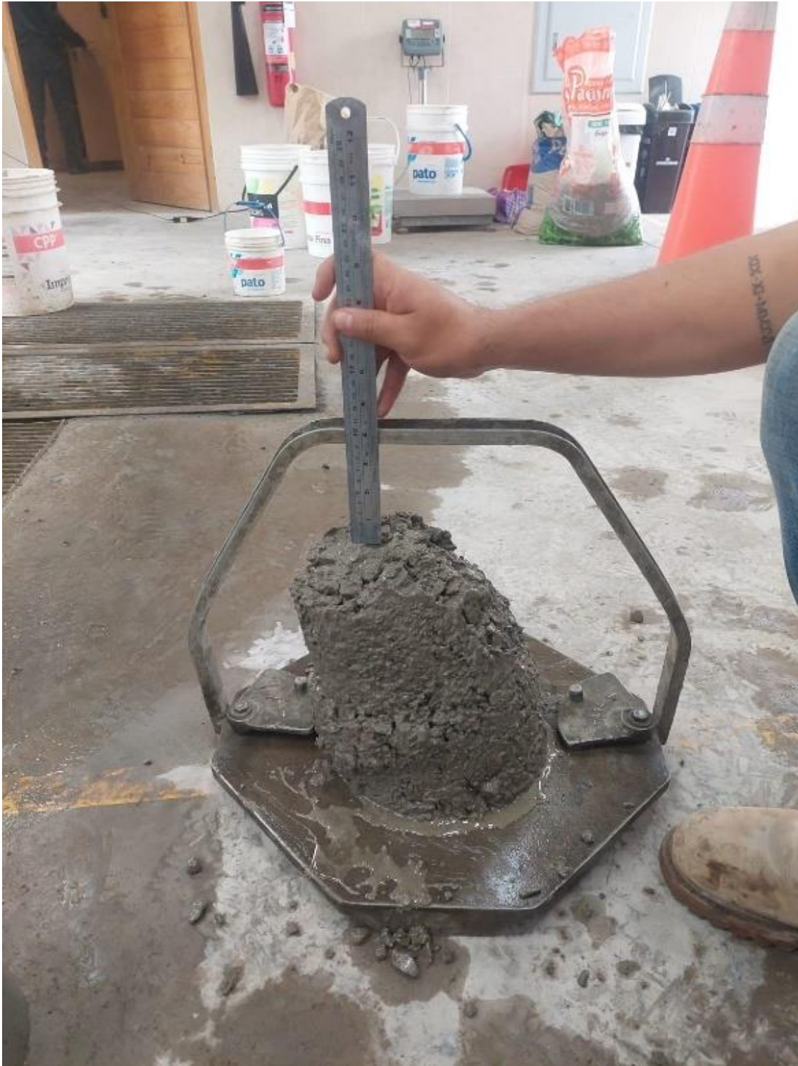
Figura 70 Asentamiento del concreto al 20% de agregado reciclado
