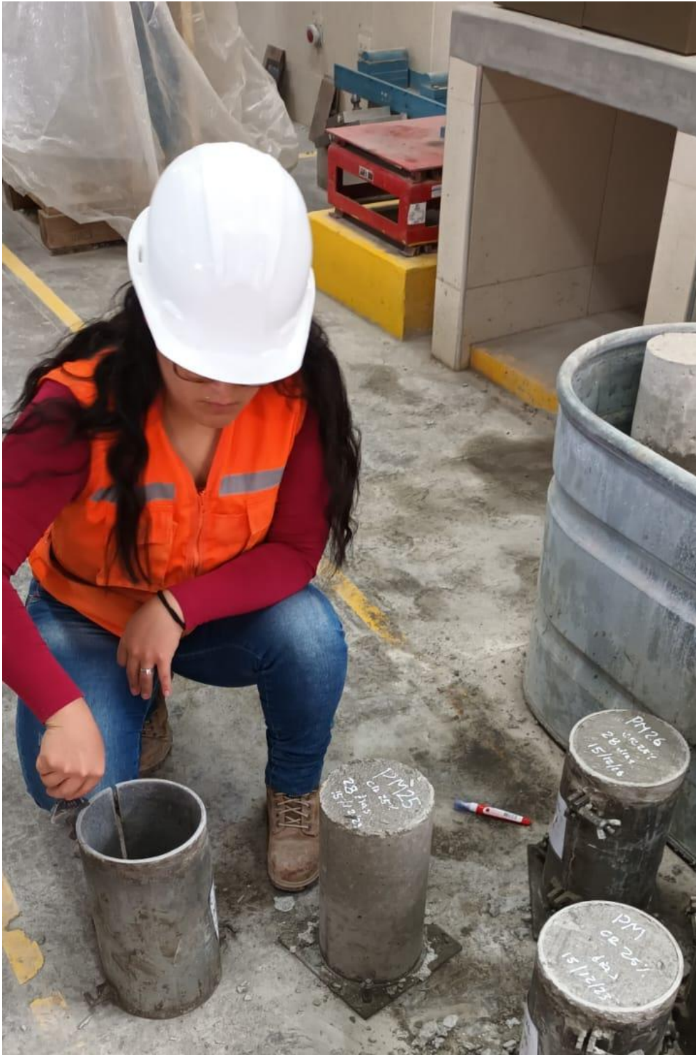
Figura 77 Desmoldado de probetas por la tesista Lily
