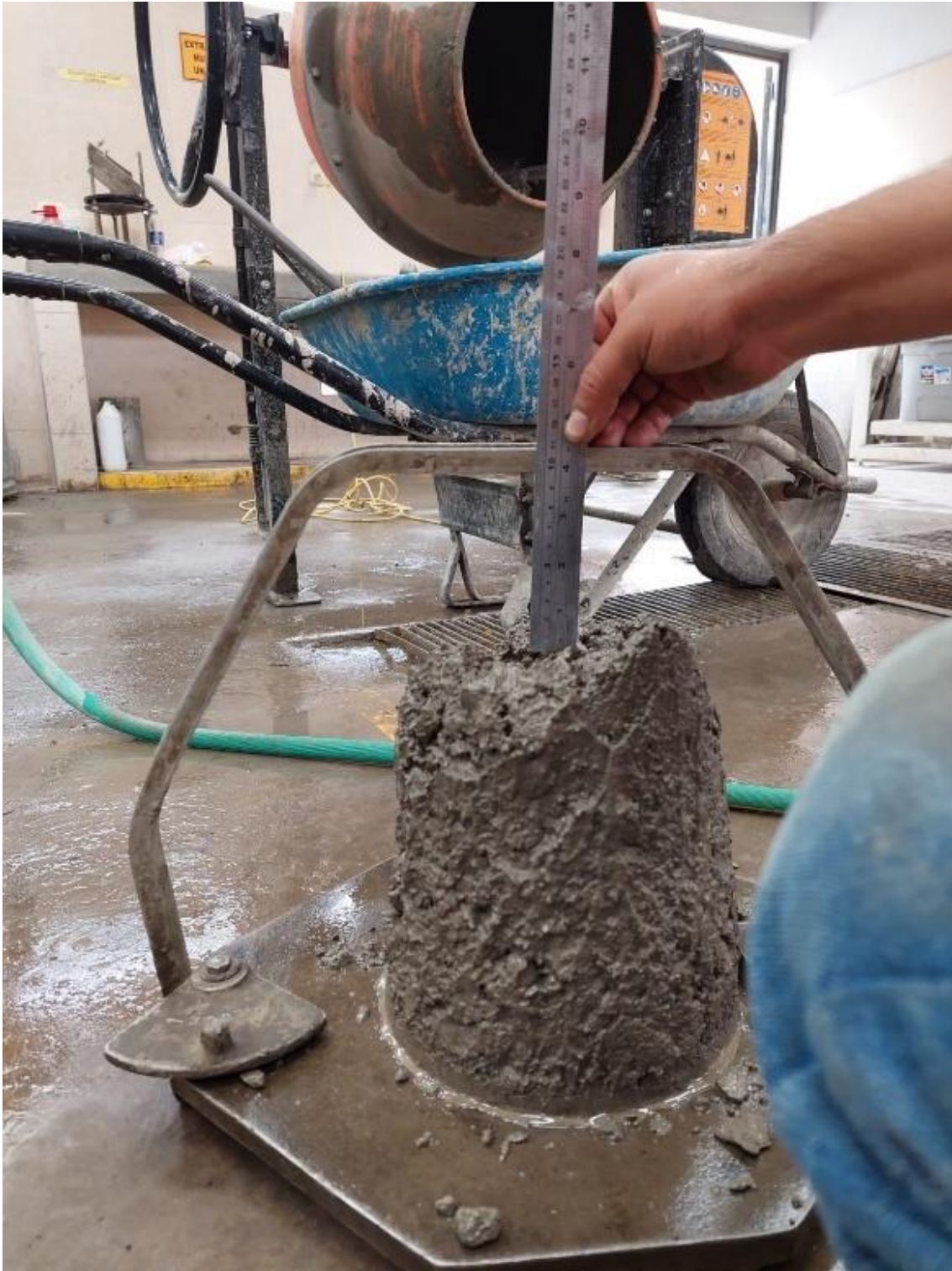
Figura 71 Asentamiento del concreto al 25% de agregado reciclado
