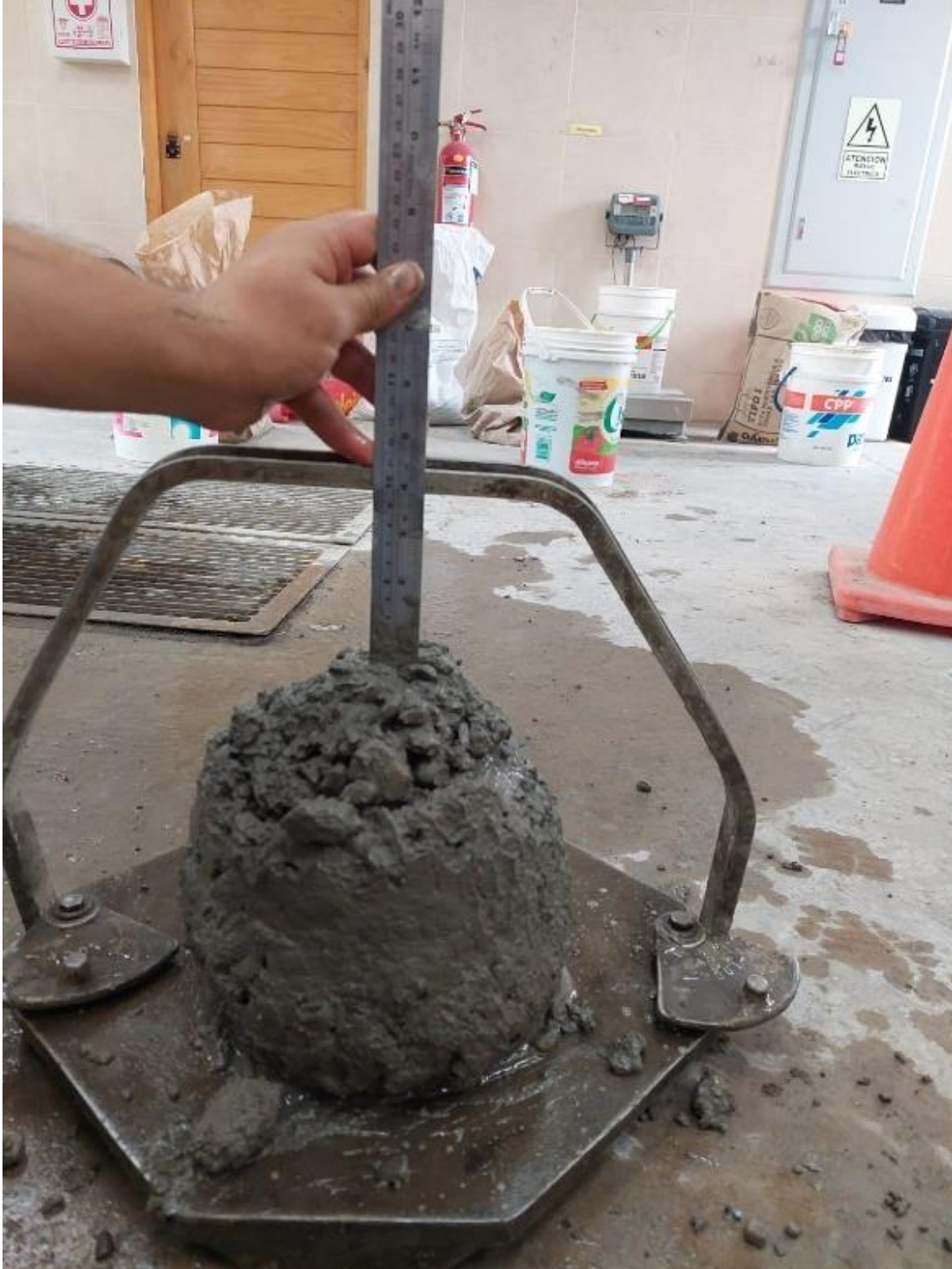
Figura 72 Asentamiento del concreto al 30% de agregado reciclado
