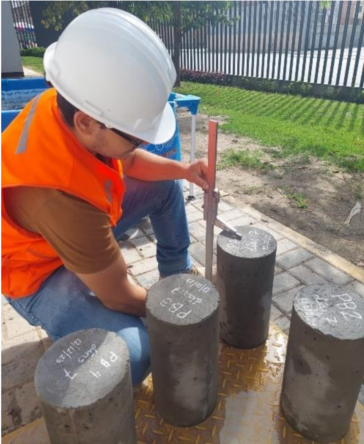
Figura 82 Medición de los testigos de concreto por el tesista Diego
