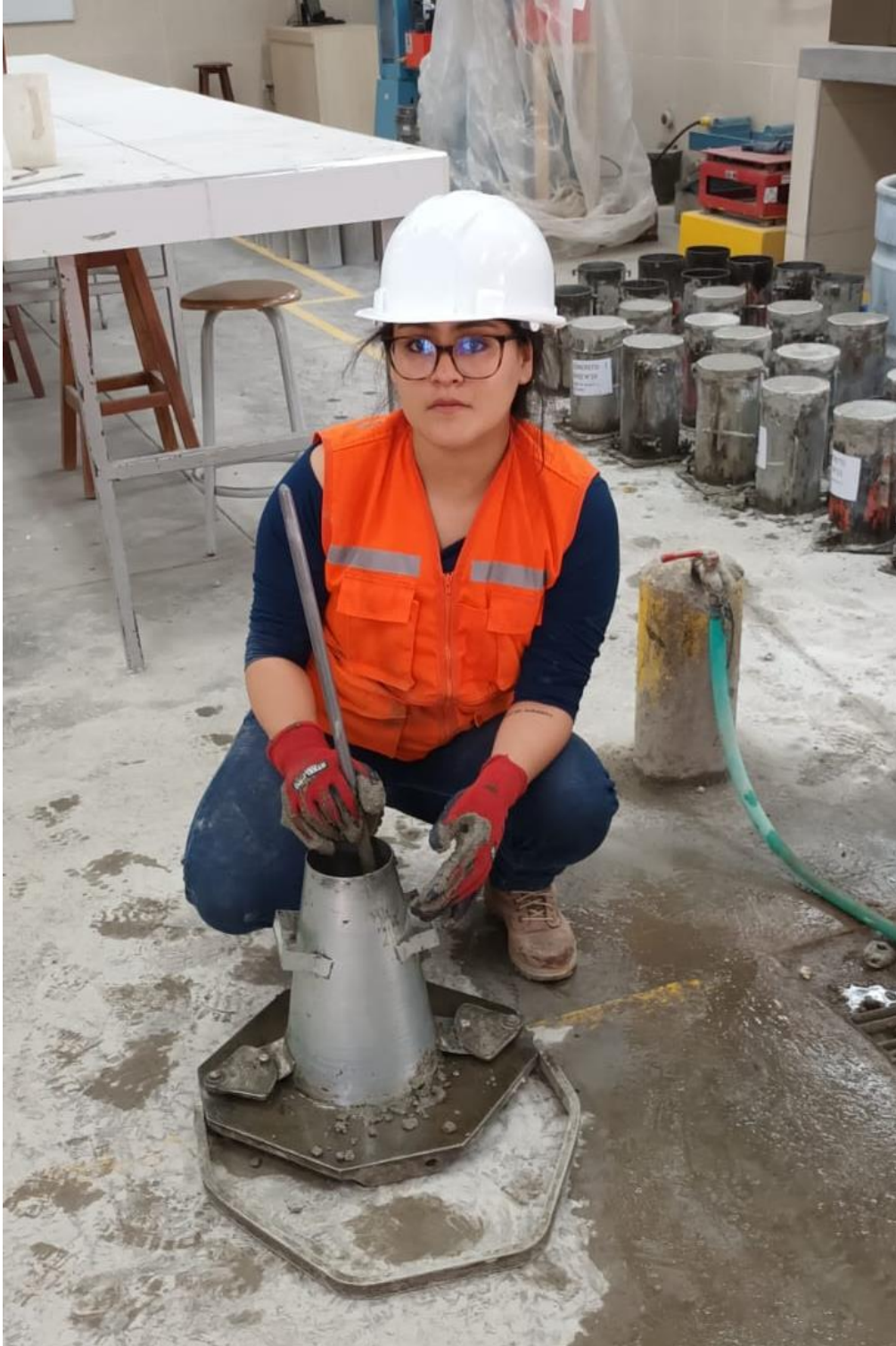
Figura 66 Chuzado para la prueba de Slump
