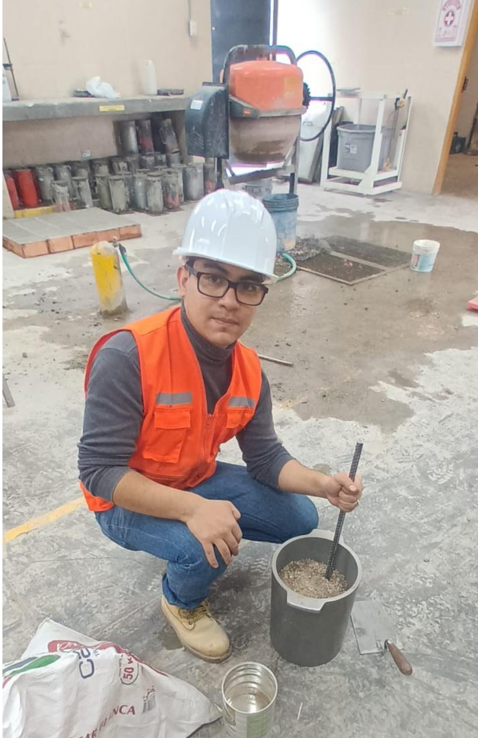
Figura 58 Ensayo de peso suelto y unitario del agregado fino
