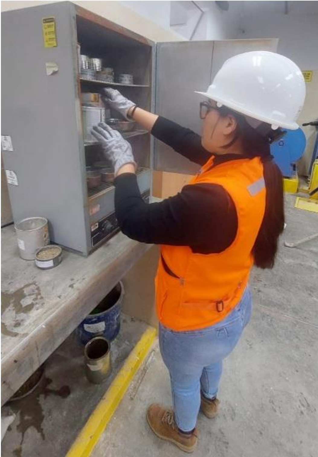
Figura 51 Colocación de agregado al horno para su posterior ensayo de peso específico y absorción por la tesista Lily
