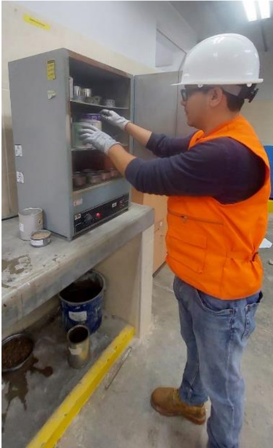
Figura 52 Colocación de agregado al horno para su posterior ensayo de peso específico y absorción por el tesista Diego
