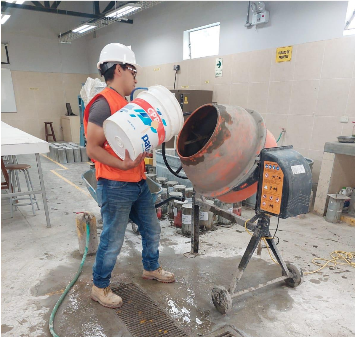
Figura 64 Vaciado de agregados para la mezcla en el trompo
