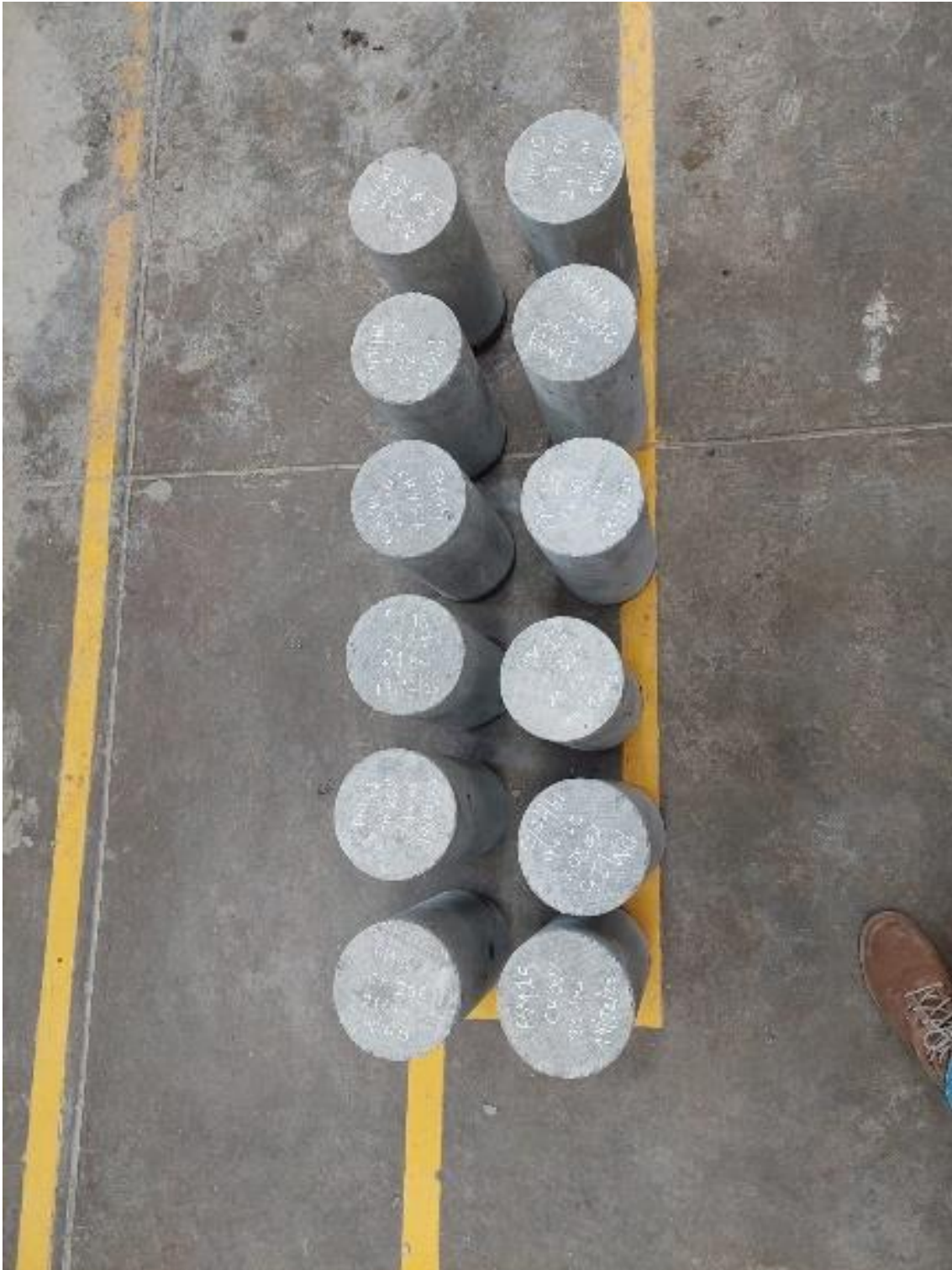
Figura 81 Colocación de testigos de concreto para la prueba de compresión a la resistencia
