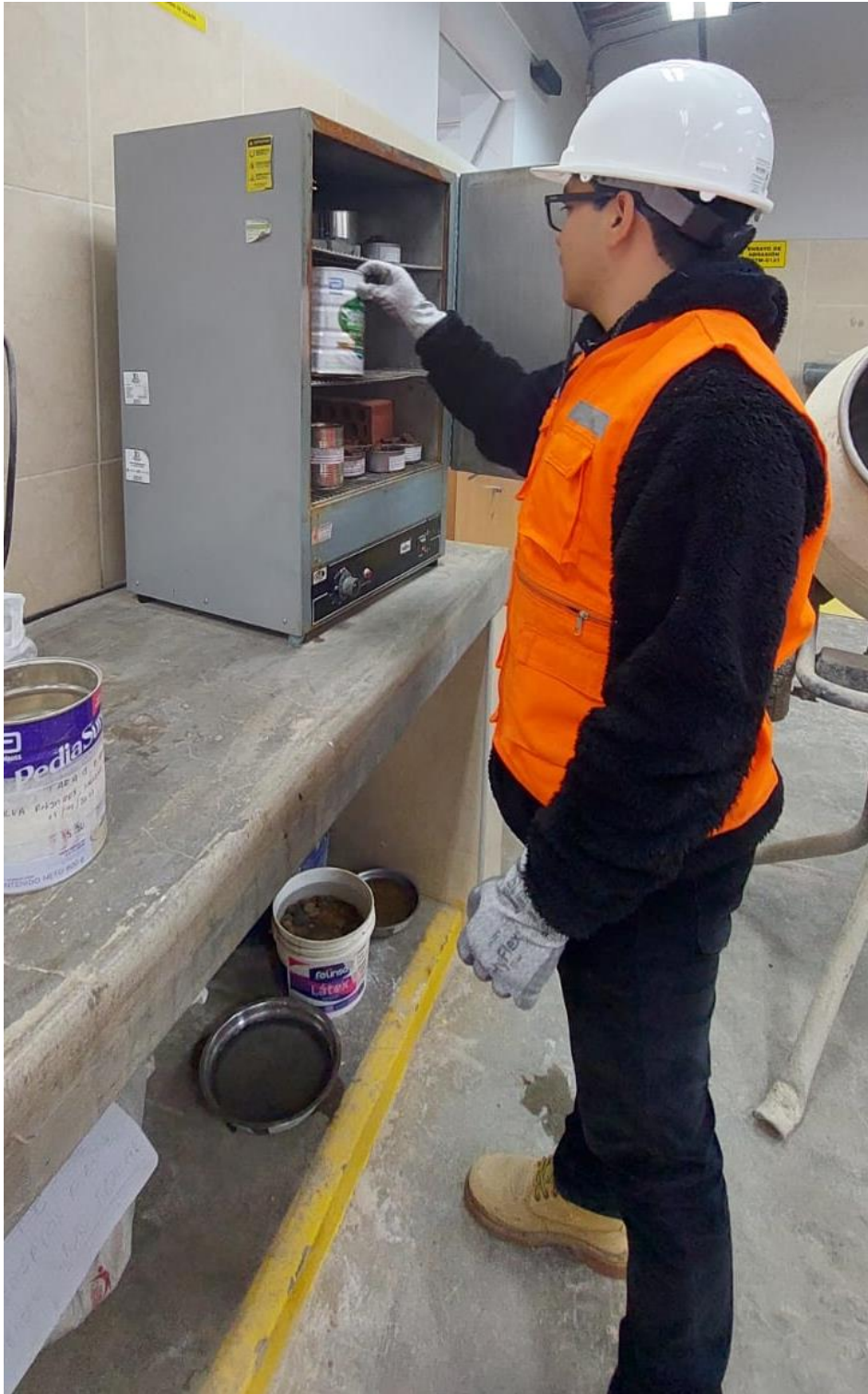
Figura 47 Colocación de agregado al horno para su posterior ensayo de granulometría por el tesista Diego
