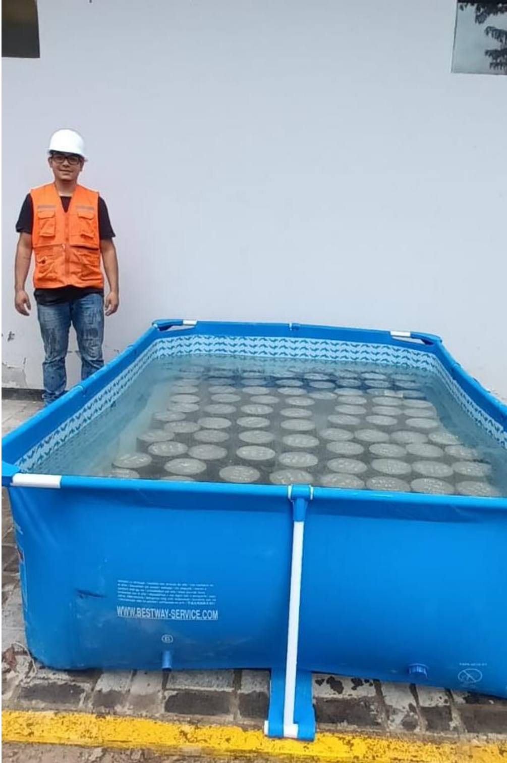
Figura 78 Curado de testigos de concreto 1
