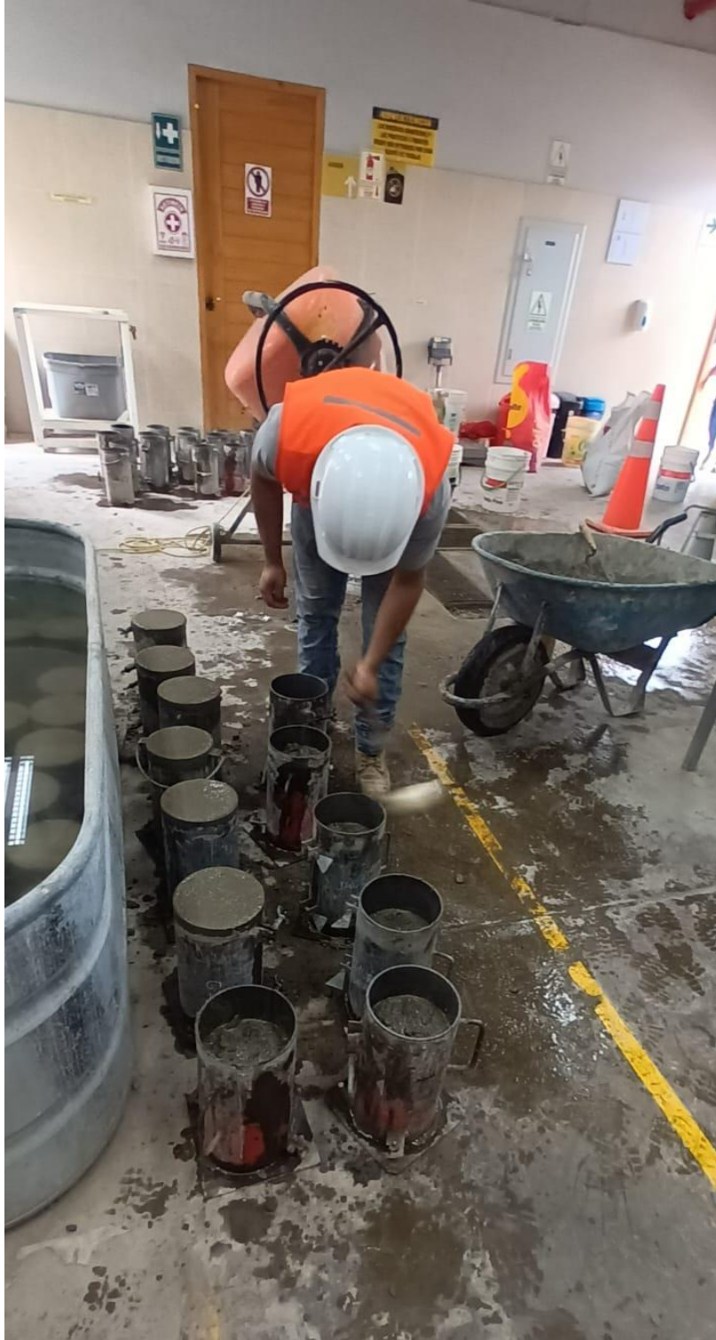
Figura 74 Golpeado con mazo de goma a las probetas
