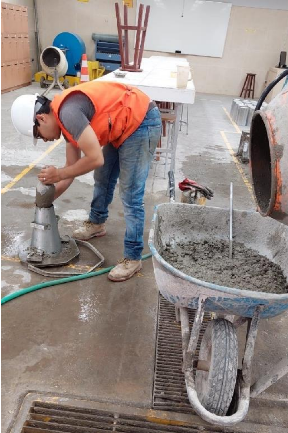
Figura 65 Vaciado de concreto para la prueba de Slump
