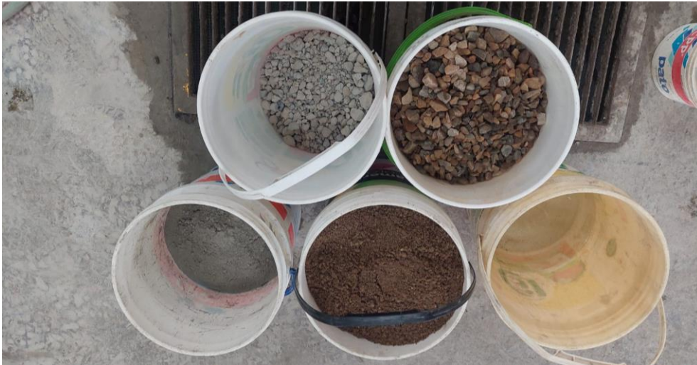
Figura 63 Pesaje de agregados, cemento y agua para la primera tanda de vaciado
