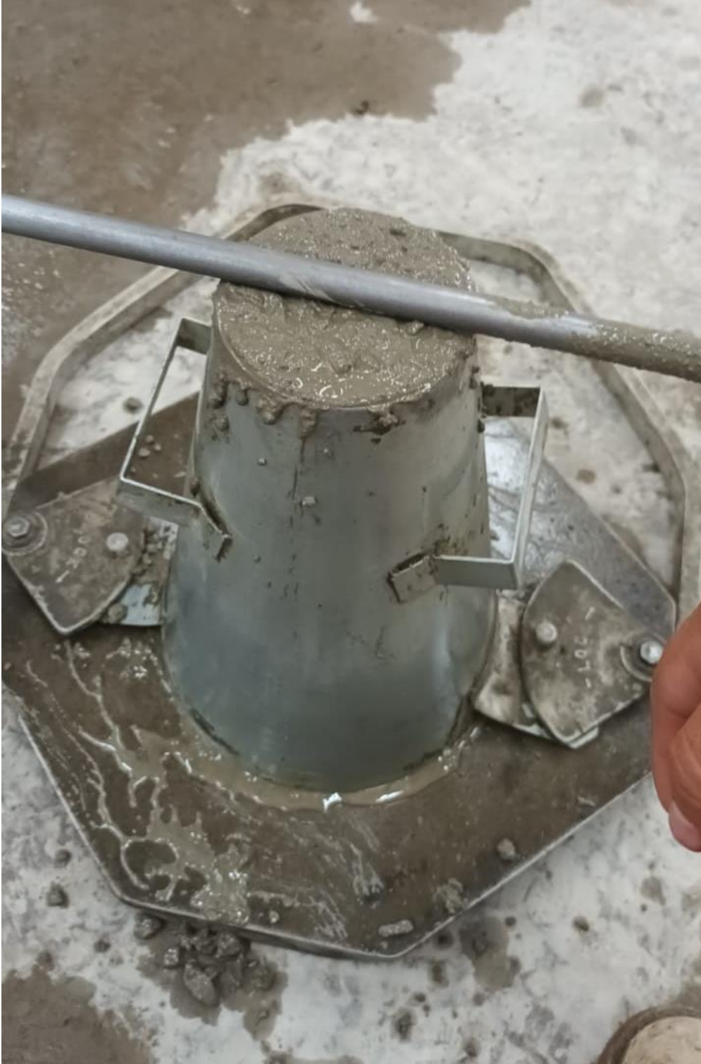
Figura 67 Enrasado para la prueba de Slump
