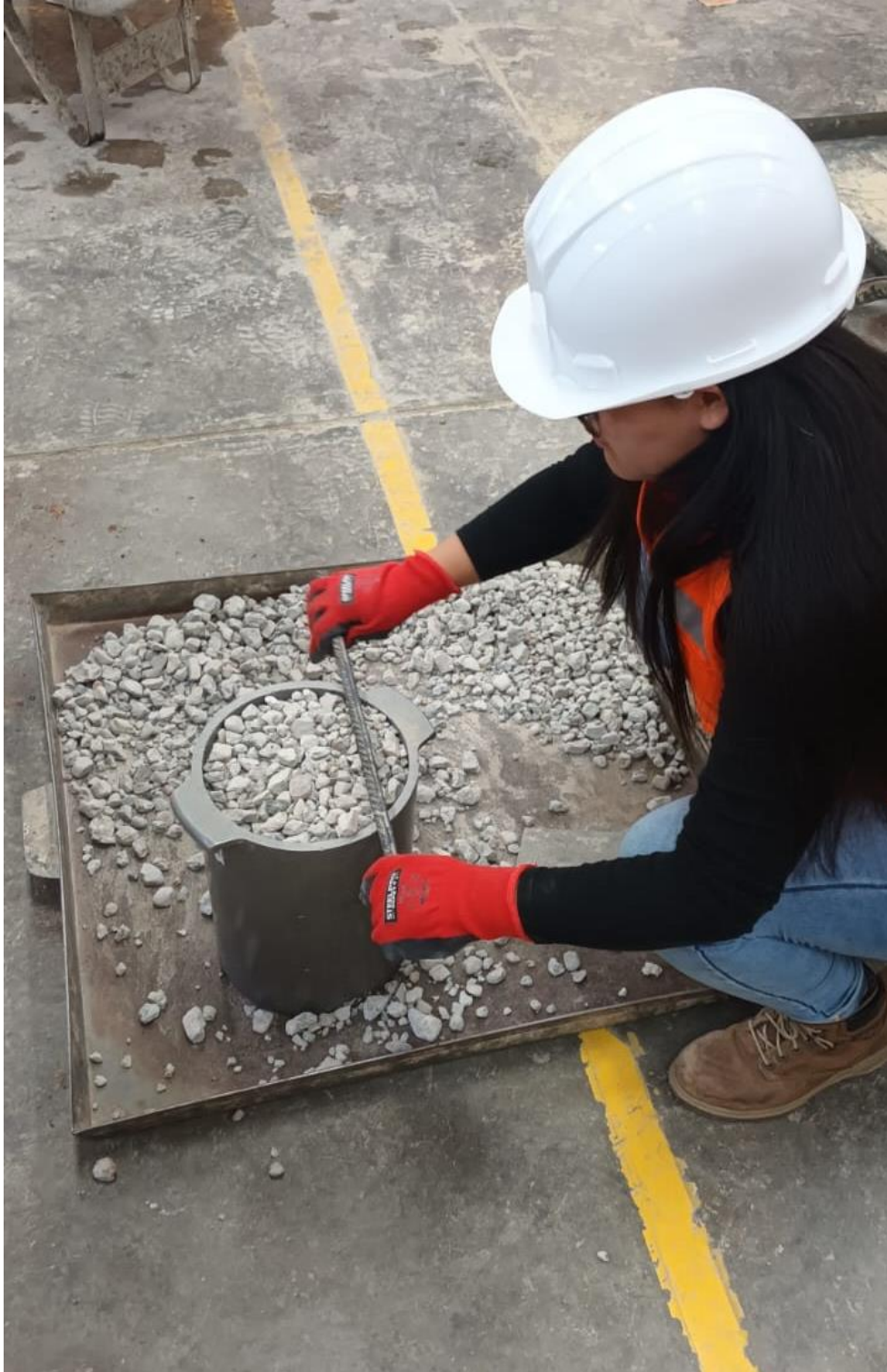
Figura 59 Ensayo de peso suelto y unitario del agregado grueso
