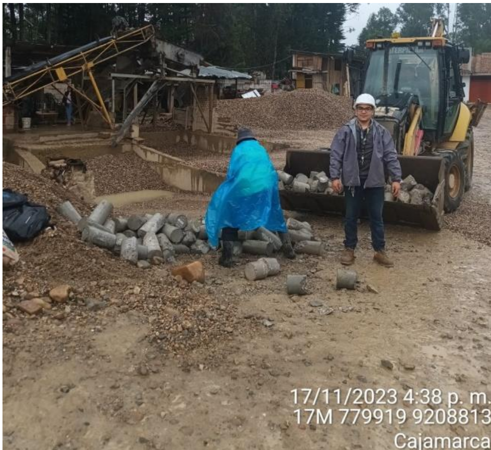
Figura 44 Colocación para la posterior trituración de las probetas de concreto
