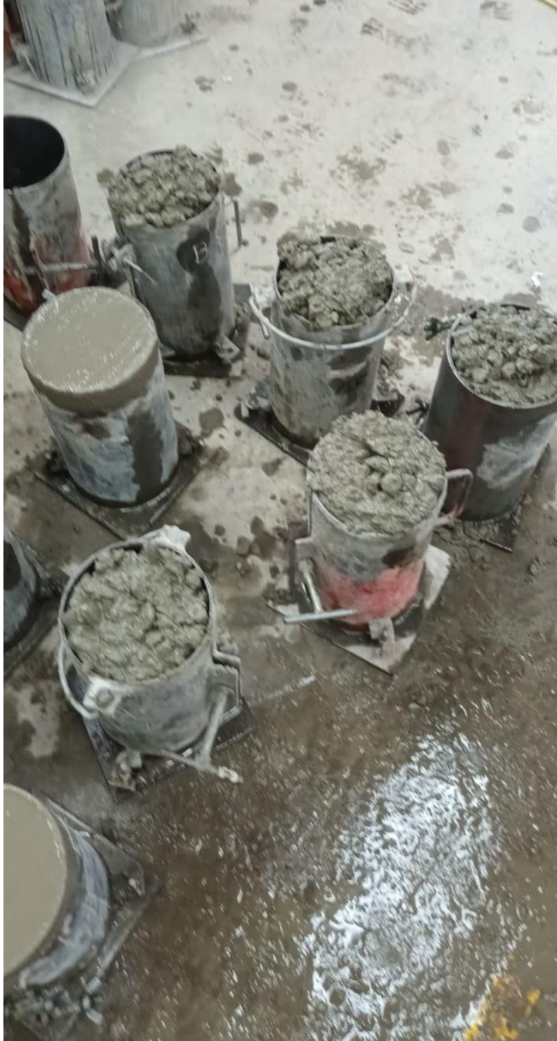
Figura 75 Probetas enrasadas y sin enrasar
