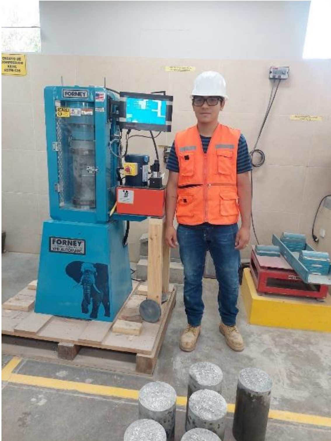
Figura 87 Prueba de resistencia a la compresión 4
