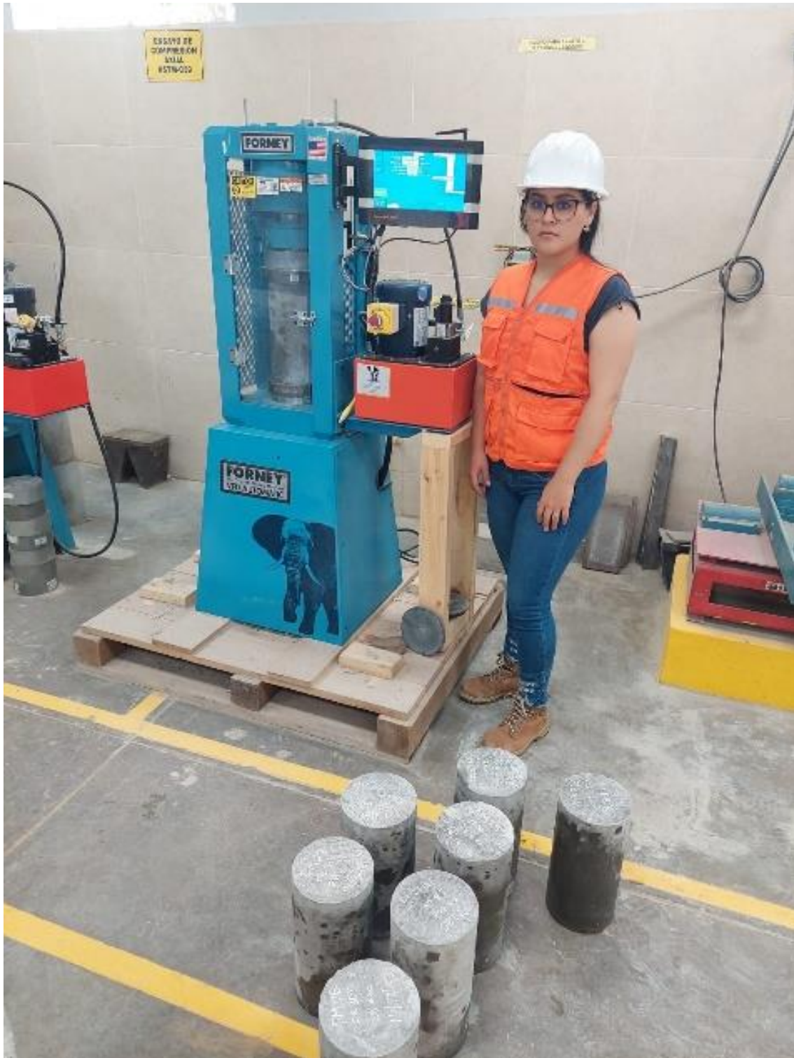
Figura 88 Prueba de resistencia a la compresión 5
