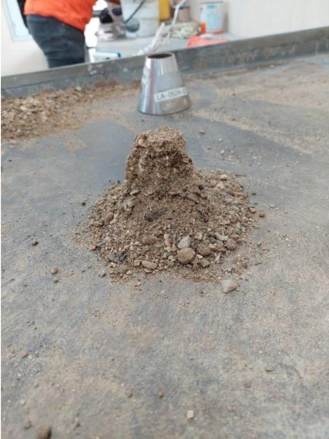
Figura 55 Prueba de secado del agregado fino
