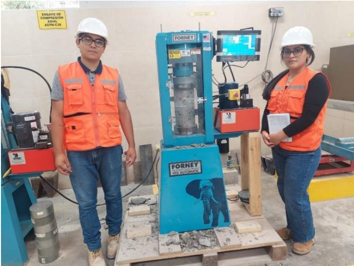
Figura 84 Prueba de resistencia a la compresión 1
