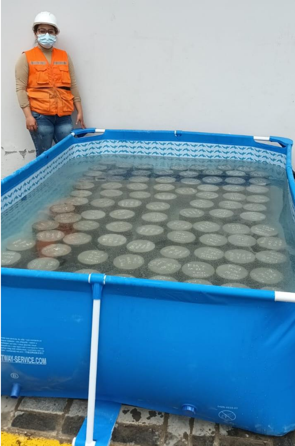
Figura 79 Curado de testigos de concreto 2
