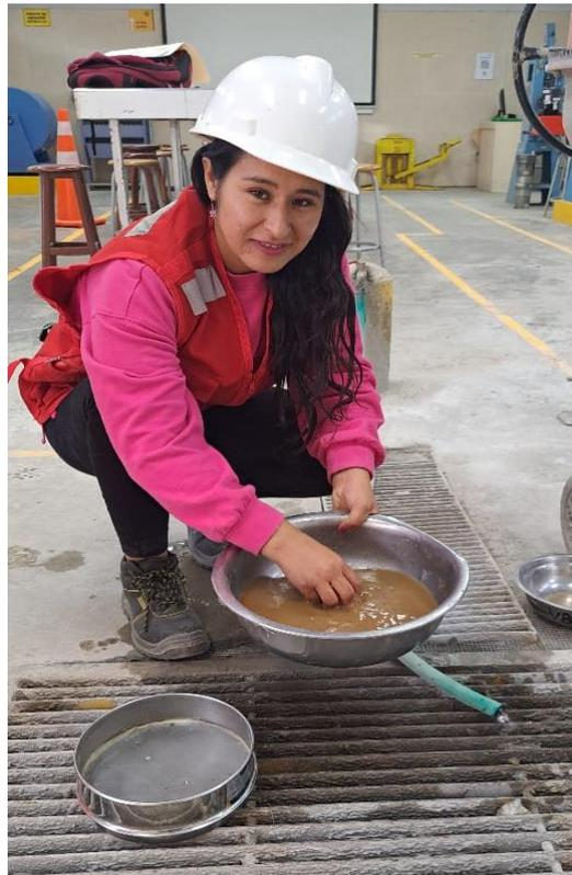
**Fotografía N° 05:** Peso específico y absorción del agregado grueso.
