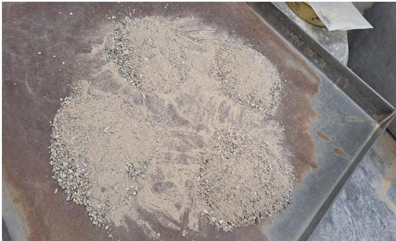
*Nota.* En la figura se muestra el cuarteo de los agregados para el tamizado.
