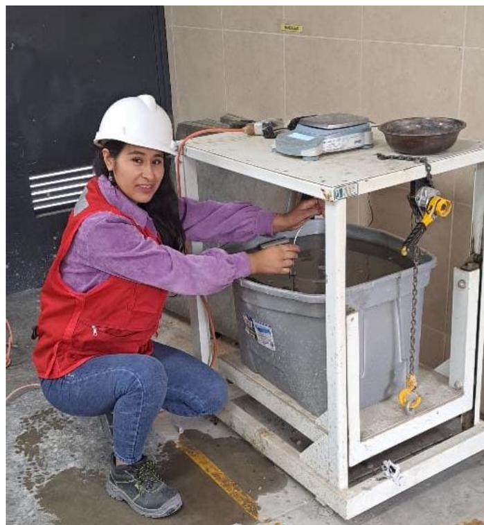
**Fotografía N° 06:** Gravedad específica y absorción de agregados finos.
