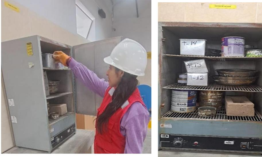
*Nota.* La figura muestra el secado en estufa de los agregados
