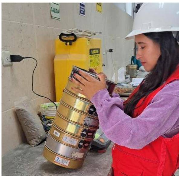
*Nota.* La figura muestra el tamizado manual de los agregados
